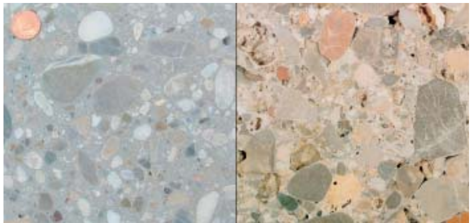
Abb. 1: links: Schnitt durch einen Beton (Größtkorn 32 mm)
