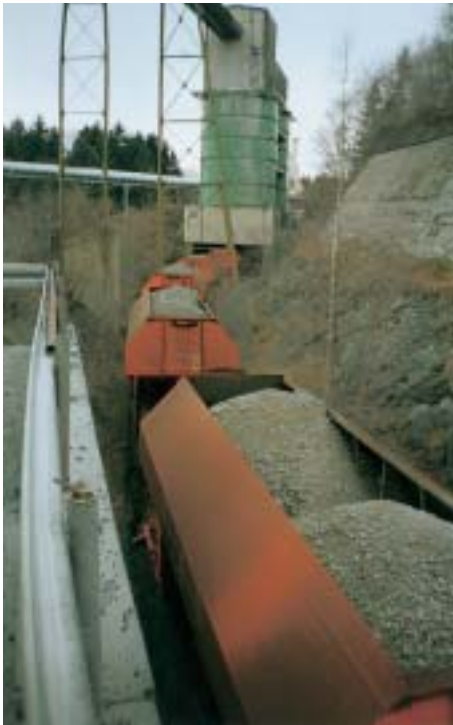
Abb. 7: Beladung des Zugverbandes für die Belieferung der Zementwerke (Warstein)
