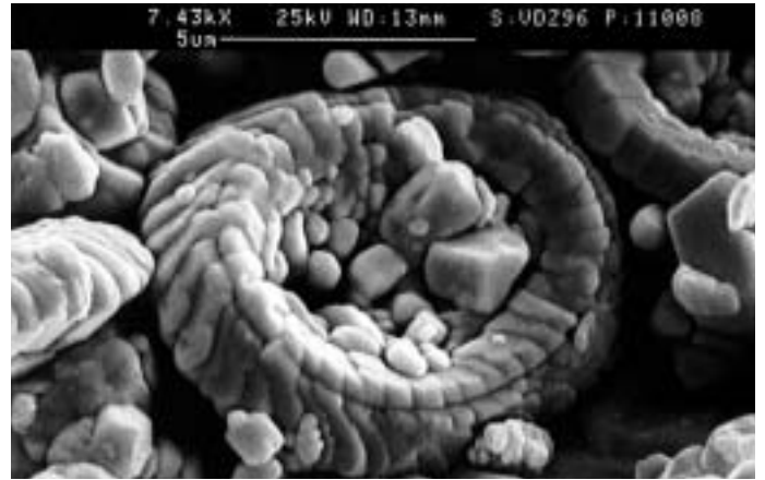
Abb. 3: REM-Aufnahme von Kreidepartikeln
