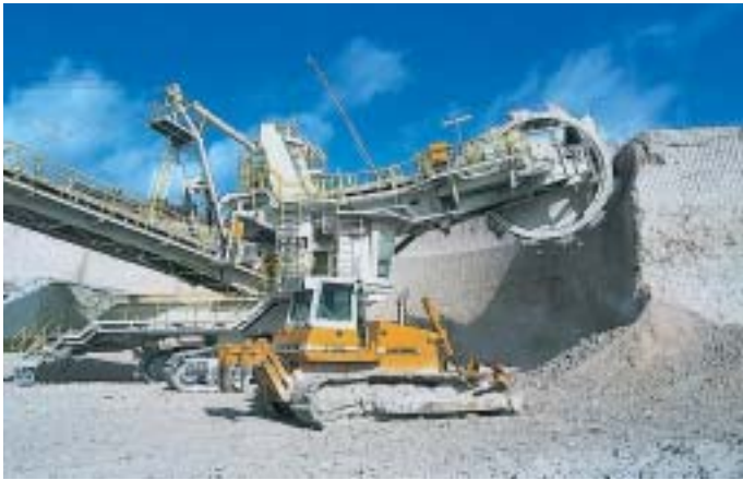
Abb. 2: Schaufelradbagger in der Grube Heidestraße bei Lägerdorf
