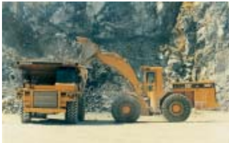
Abb. 6: Verladung des gesprengten Haufwerks zum Transport in die Brechanlage des Schotterwerks (Warstein)
