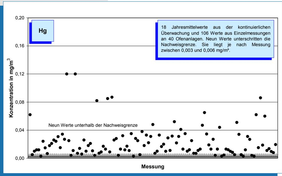
**Bild 5-29: Messwerte (Jahr 2004) der Quecksilber-Konzentration im Reingas von 40 Drehofenanlagen.**
