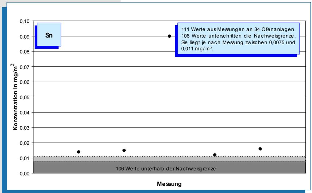
**Bild 5-49: Messwerte (Jahr 2004) der Zinn-Konzentration im Reingas von 34 Drehofenanlagen.**
