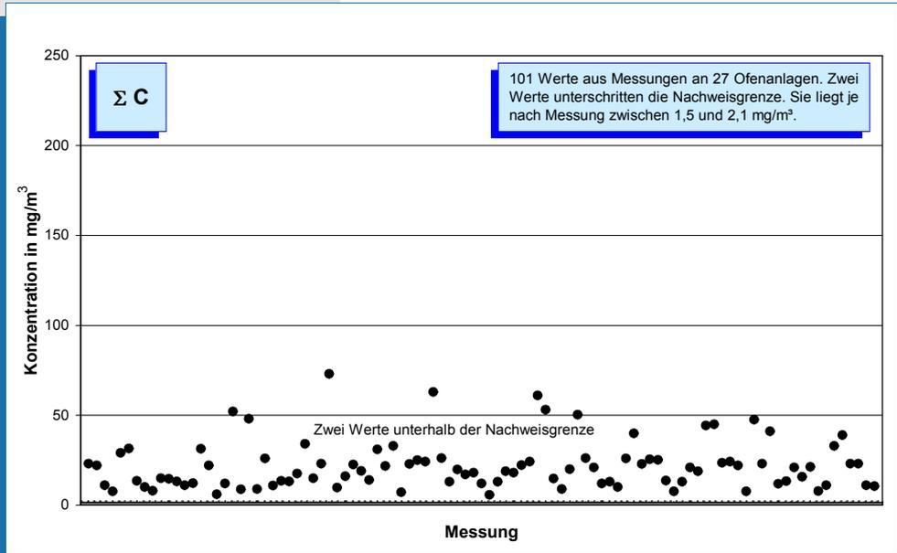
**Bild 5-9: Messwerte (Jahr 2004) der Konzentration von organischem Gesamtkohlenstoff im Reingas von 27 Drehofenanlagen.**
