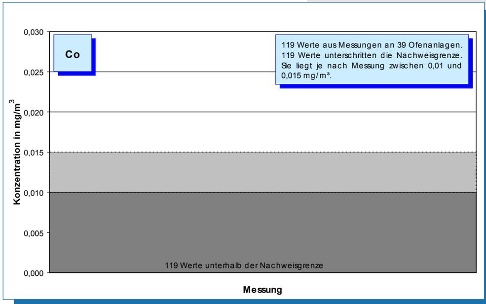
**Bild 5-39: Messwerte (Jahr 2004) der Cobalt-Konzentration im Reingas von 39 Drehofenanlagen.**
