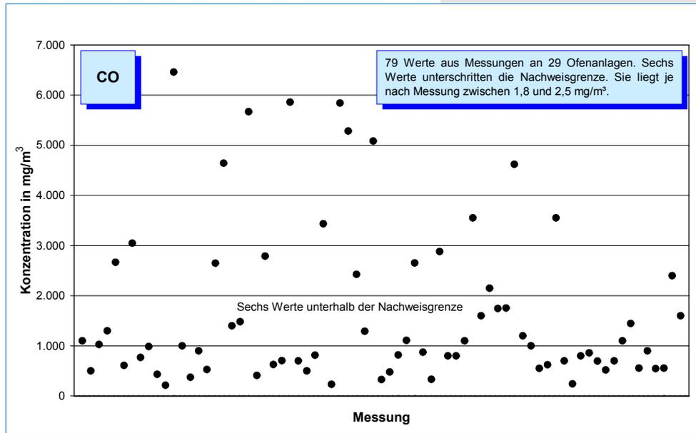
Bild 5-7: Messwerte (Jahr 2004) der CO-Konzentration im Reingas von 29 Drehofenanlagen.
