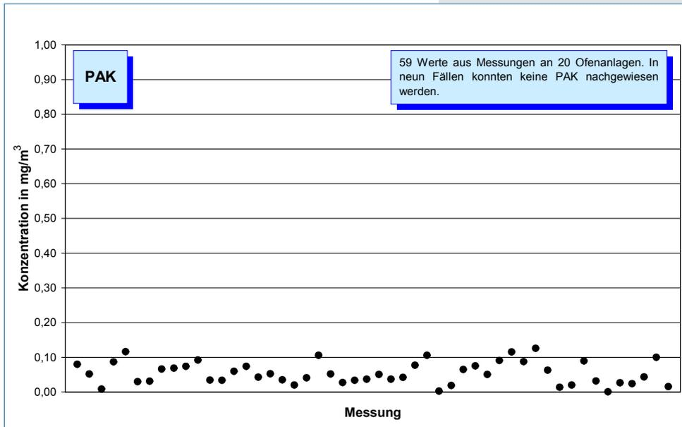
Im Abgas von Drehofenanlagen der Zementindustrie liegt i. allg. eine Verteilung der PAK (nach EPA 610) vor, in der Naphthalin mit einem Massenanteil von über 90 % dominiert. In Drehofenanlagen der Zementindustrie ist eine praktisch vollständige Zerstörung der aus den Brennstoffen stammenden PAK gewährleistet.
