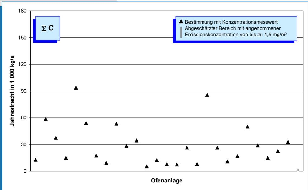
**Bild 5-10: Emissionen von organischem Gesamtkohlenstoff (Jahresfracht 2004) von 27 Drehofenanlagen.**
