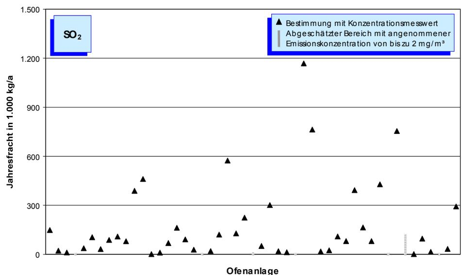
Bild 5-6: SO<sub>2</sub>-Emissionen (Jahresfracht 2004) von 49 Drehofenanlagen. Bei Messungen unterhalb der Nachweisgrenze kann die Fracht nur abgeschätzt werden. Der Bereich möglicher Emissionen ist in diesen Fällen als Linie dargestellt, deren Obergrenze mit einer Konzentration von 2 mg/m<sup>3</sup> berechnet wurde.
