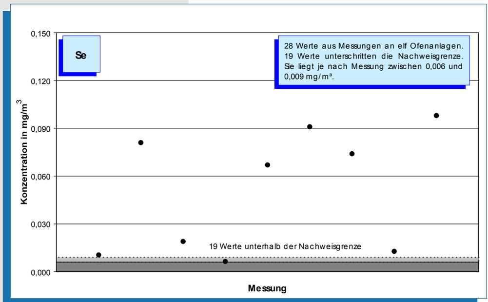
**Bild 5-53: Messwerte (Jahr 2004) der Selen-Konzentration im Reingas von elf Drehofenanlagen.**
