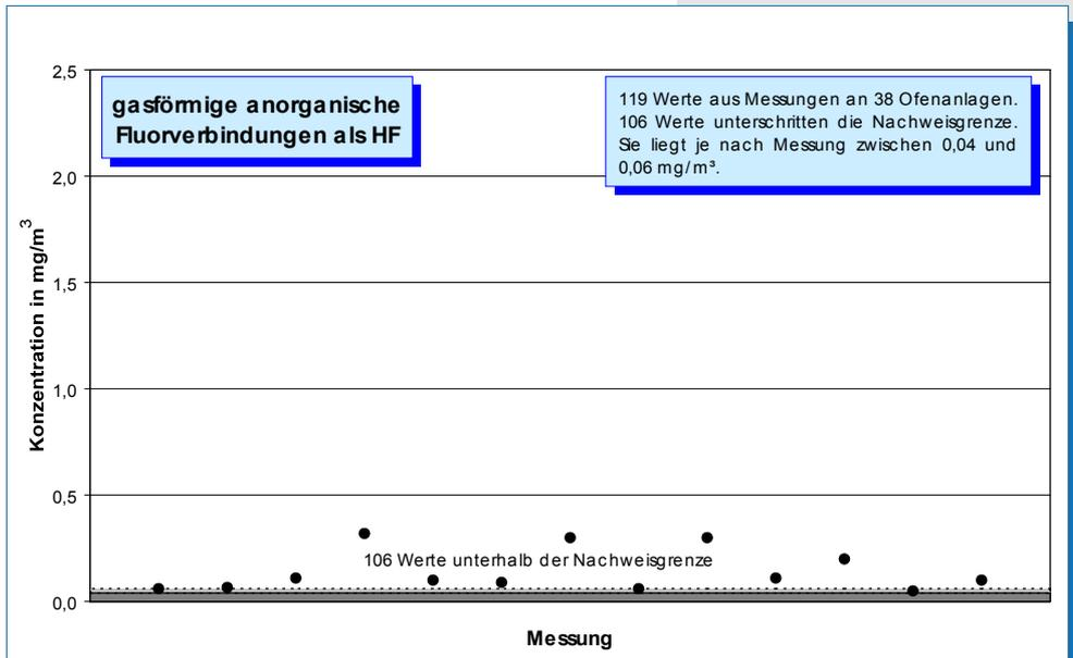
**Bild 5-23:** Messwerte (Jahr 2004) der Konzentration gasförmiger anorganischer Fluorverbindungen, berechnet als HF, im Reingas von 38 Drehhofenanlagen.
