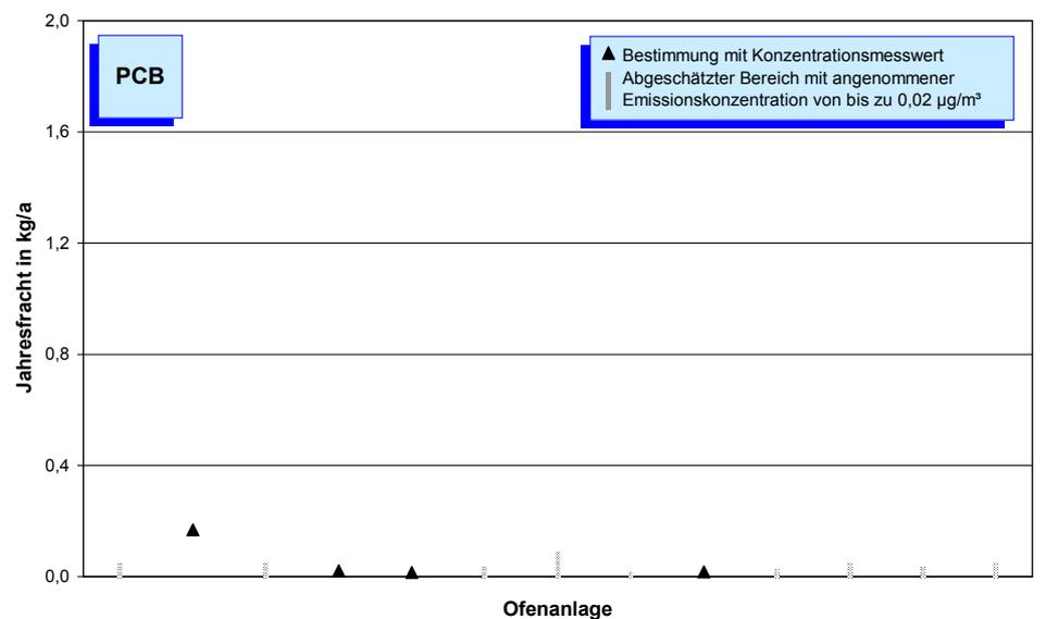
**Bild 5-14:** PCB-Emissionen (Jahresfracht 2004) von 13 Drehofenanlagen.
