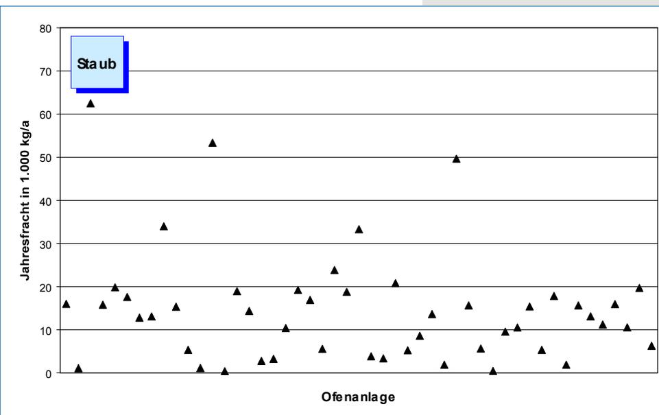
Bild 5-2: Staub-Emissionen (Jahresfracht 2004) von 49 Drehofenanlagen.
