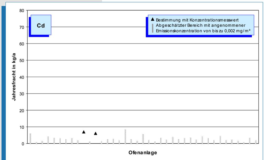
Bild 5-26: Cadmium-Emissionen (Jahresfracht 2004) von 39 Drehofenanlagen.
