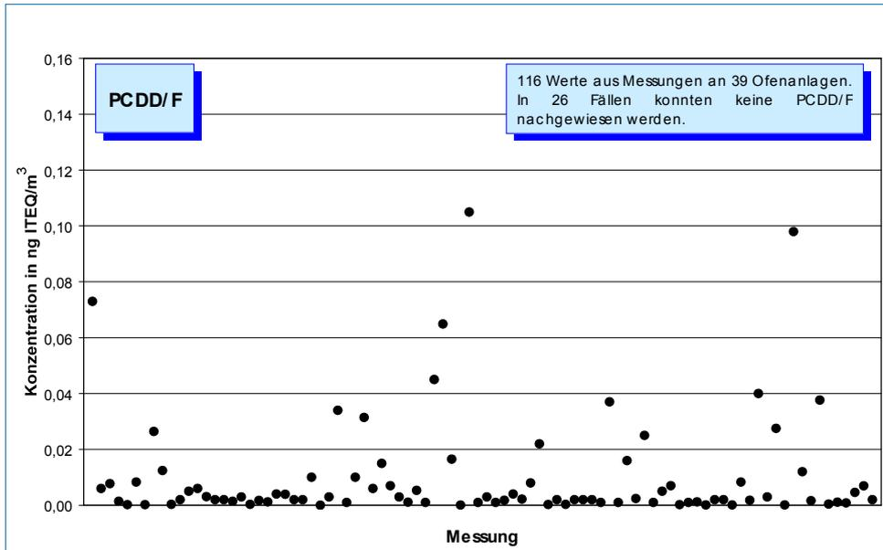
**Bild 5-11: Messwerte (Jahr 2004) der Konzentration von Dioxinen und Furanen (PCDD/F) im Reingas von 39 Drehofenanlagen. In 26 Fällen konnten keine PCDD/F nachgewiesen werden.**
