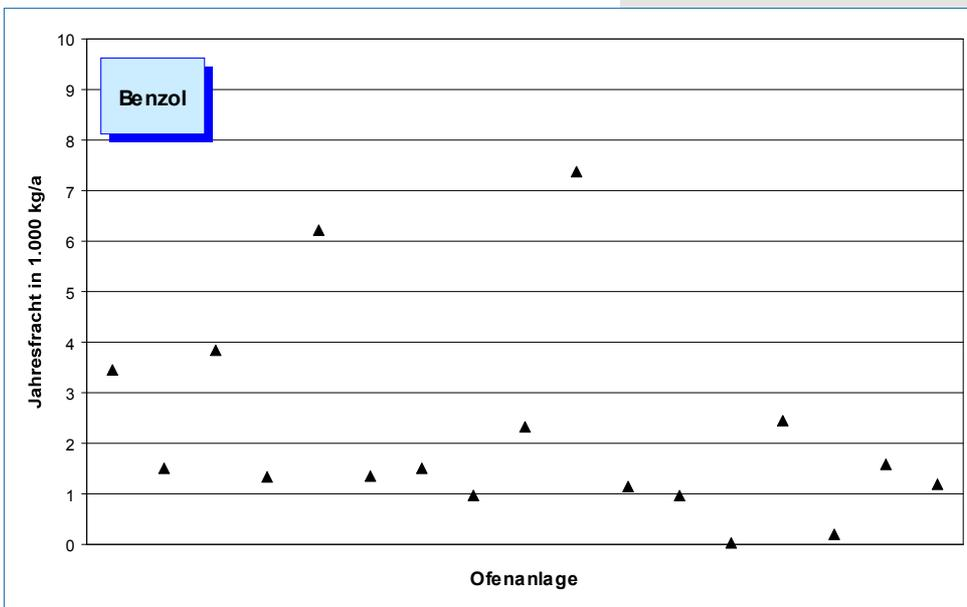
**Bild 5-20: Benzol-Emissionen (Jahresfracht 2004) von 17 Drehofenanlagen.**
