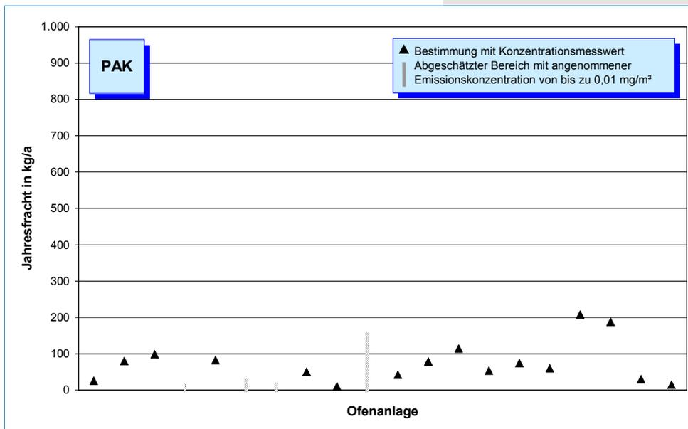
**Bild 5-16: PAK-Emissionen (Jahresfracht 2004) von 19 Drehofenanlagen.**
