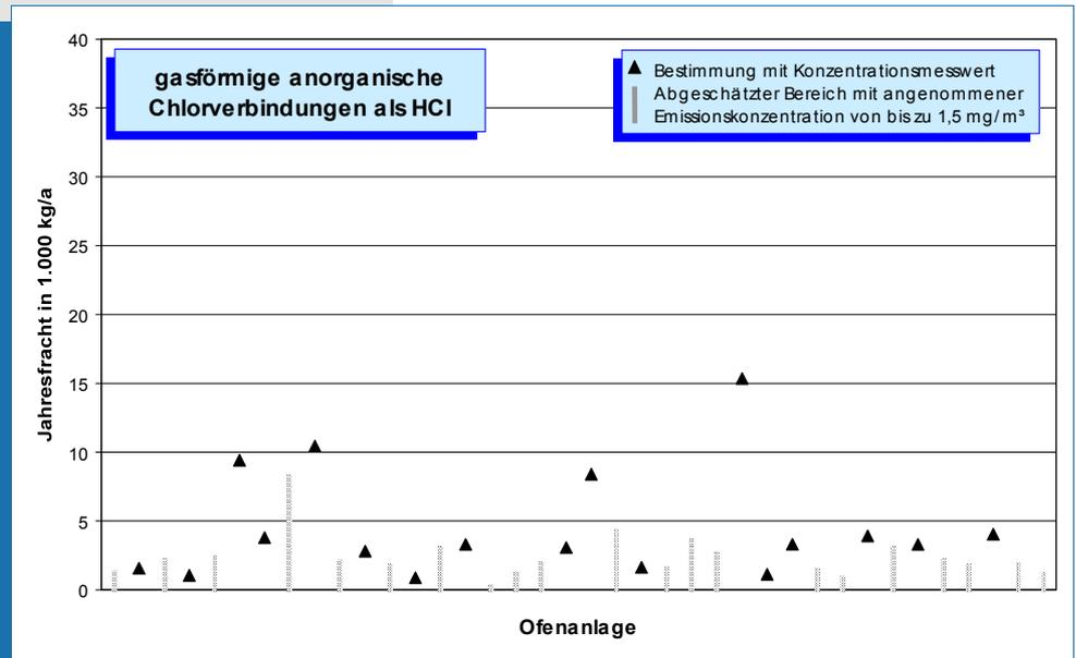
Bild 5-22: HCl-Emissionen (Jahresfracht 2004) von 38 Drehofenanlagen. Bei Messungen unterhalb der Nachweisgrenze kann die Fracht nur abgeschätzt werden. Der Bereich möglicher Emissionen ist in diesen Fällen als Linie dargestellt, deren Obergrenze mit einer Konzentration von 1,5 mg/m<sup>3</sup> berechnet wurde.
