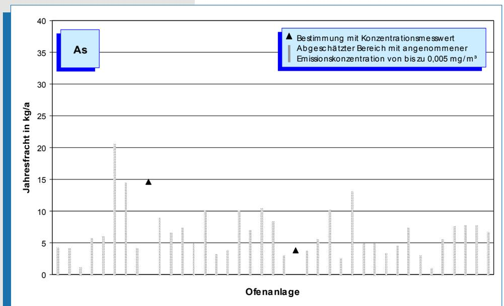
**Bild 5-34: Arsen-Emissionen (Jahresfracht 2004) von 39 Drehofenanlagen.**
