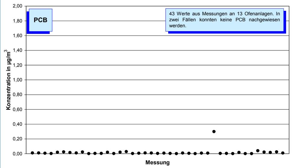
**Bild 5-13:** Messwerte (Jahr 2004) der Konzentration von polychlorierten Biphenylen (PCB nach DIN 51527) im Reingas von 13 Drehofenanlagen. In zwei Fällen konnten keine PCB nachgewiesen werden.
