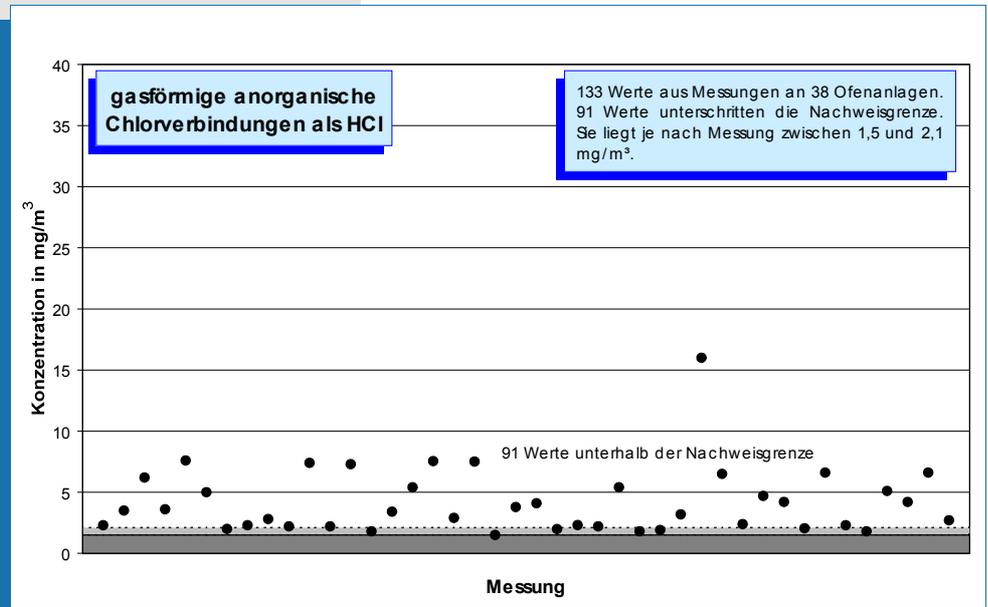
Bild 5-21: Messwerte (Jahr 2004) der Konzentrationen gasförmiger anorganischer Chlorverbindungen, berechnet als HCl, im Reingas von 38 Drehofenanlagen.
