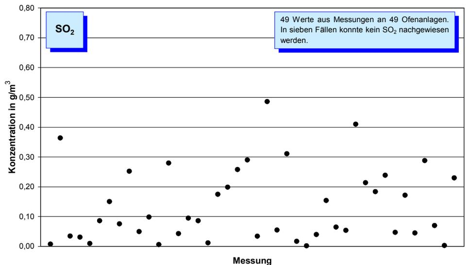
Bild 5-5: Mittelwerte (Jahr 2004) der SO<sub>2</sub>-Konzentration im Reingas von 49 Drehofenanlagen.
