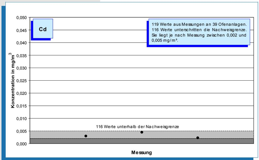
Bild 5-25: Messwerte (Jahr 2004) der Cadmium-Konzentration im Reingas von 39 Drehofenanlagen.
