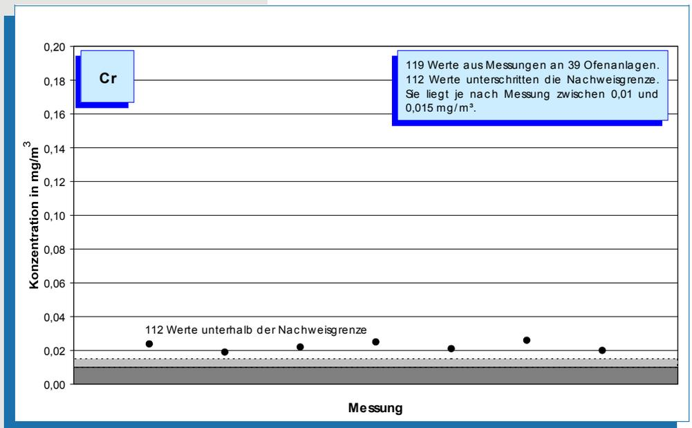
**Bild 5-37: Messwerte (Jahr 2004) der Chrom-Konzentration im Reingas von 39 Drehofenanlagen.**
