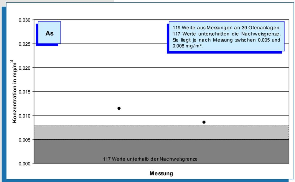
**Bild 5-33: Messwerte (Jahr 2004) der Arsen-Konzentration im Reingas von 39 Drehofenanlagen.**
