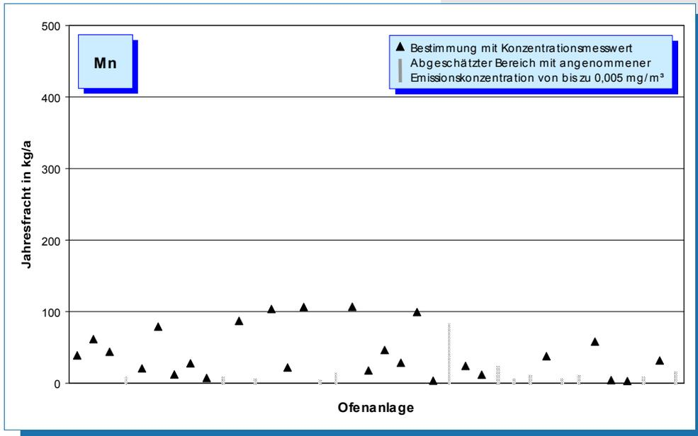
**Bild 5-44: Mangan-Emissionen (Jahresfracht 2004) von 38 Drehofenanlagen.**
