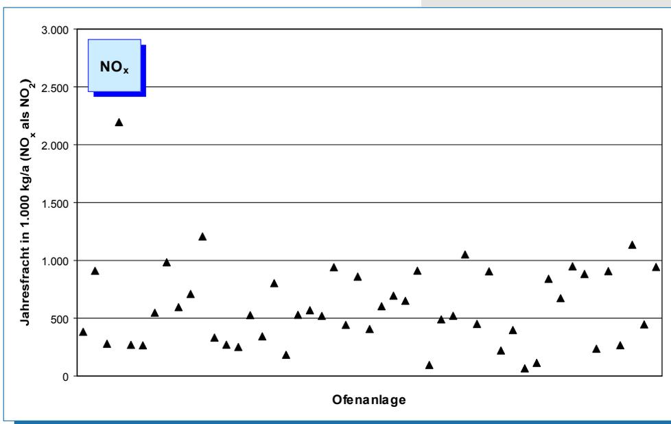
Bild 5-4: NO<sub>x</sub>-Emissionen (Jahresfracht 2004) von 49 Drehofenanlagen.
