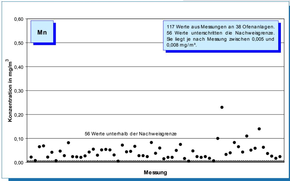
**Bild 5-43: Messwerte (Jahr 2004) der Mangan-Konzentration im Reingas von 38 Drehofenanlagen.**
