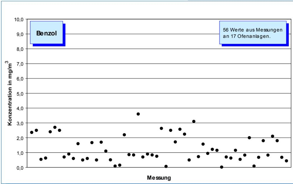
Benzol entsteht bei der thermischen Zersetzung organischer Bestandteile des Rohmaterials im Vorwärmer. Es ist i. Allg. zu mehr als der Hälfte an den Emissionen von BTEX beteiligt.
