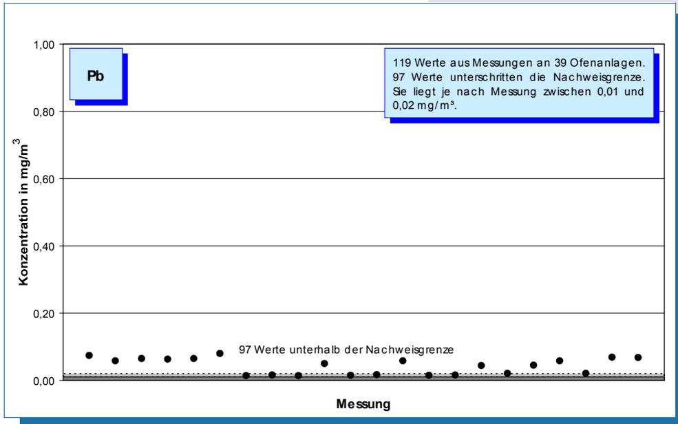
**Bild 5-35: Messwerte (Jahr 2004) der Blei-Konzentration im Reingas von 39 Drehofenanlagen.**
