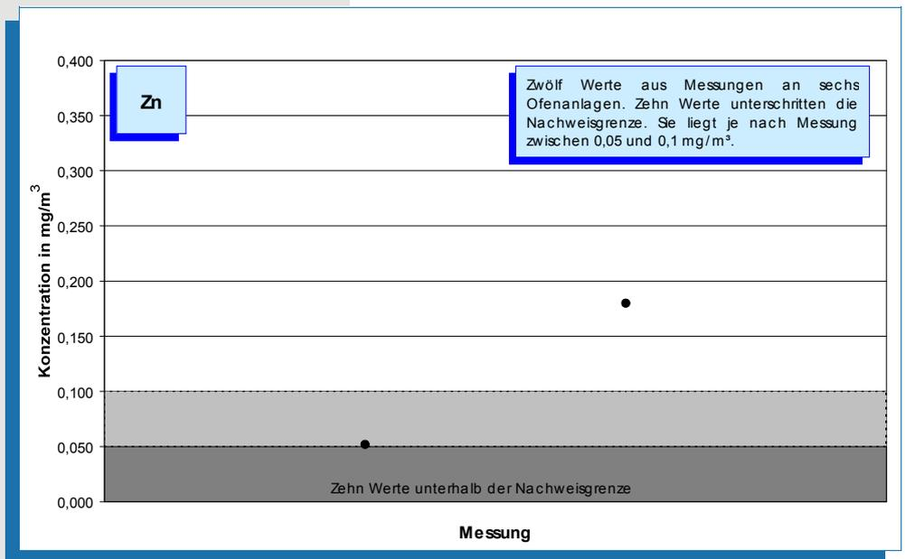
**Bild 5-57: Messwerte (Jahr 2004) der Zink-Konzentration im Reingas von sechs Drehofenanlagen.**
