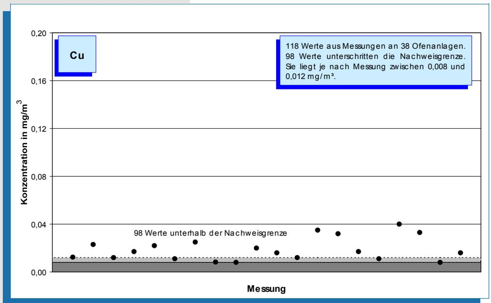
**Bild 5-41: Messwerte (Jahr 2004) der Kupfer-Konzentration im Reingas von 38 Drehofenanlagen.**
