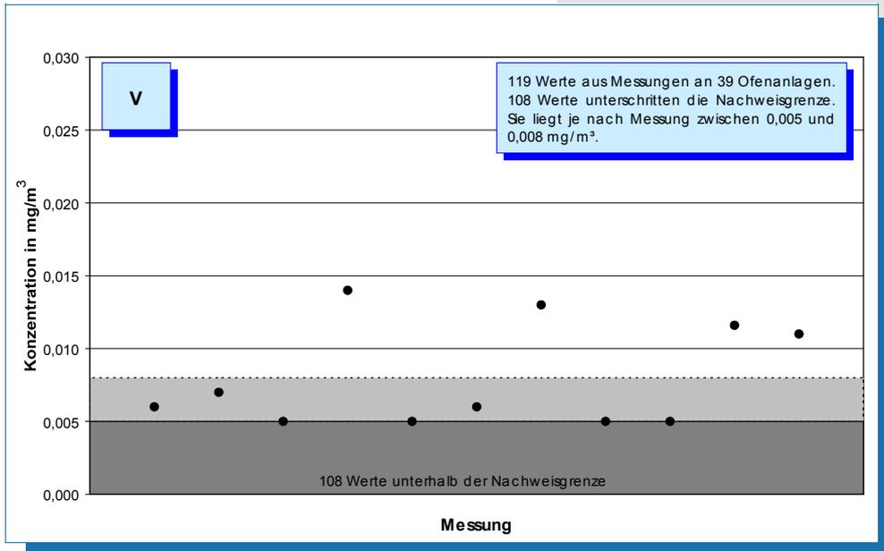
**Bild 5-47: Messwerte (Jahr 2004) der Vanadium-Konzentration im Reingas von 39 Drehofenanlagen.**
