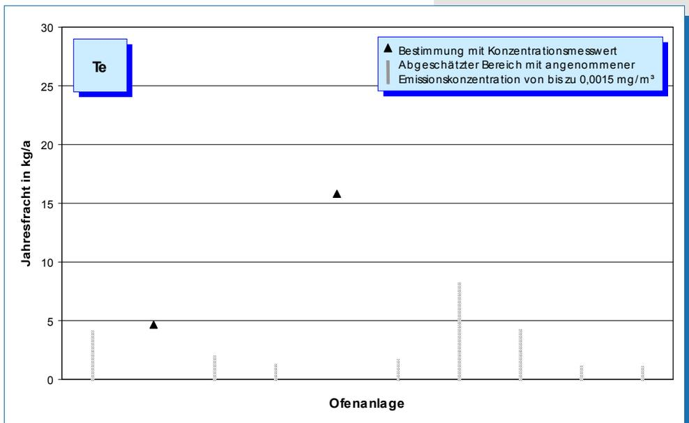
**Bild 5-56: Tellur-Emissionen (Jahresfracht 2004) von zehn Drehofenanlagen.**
