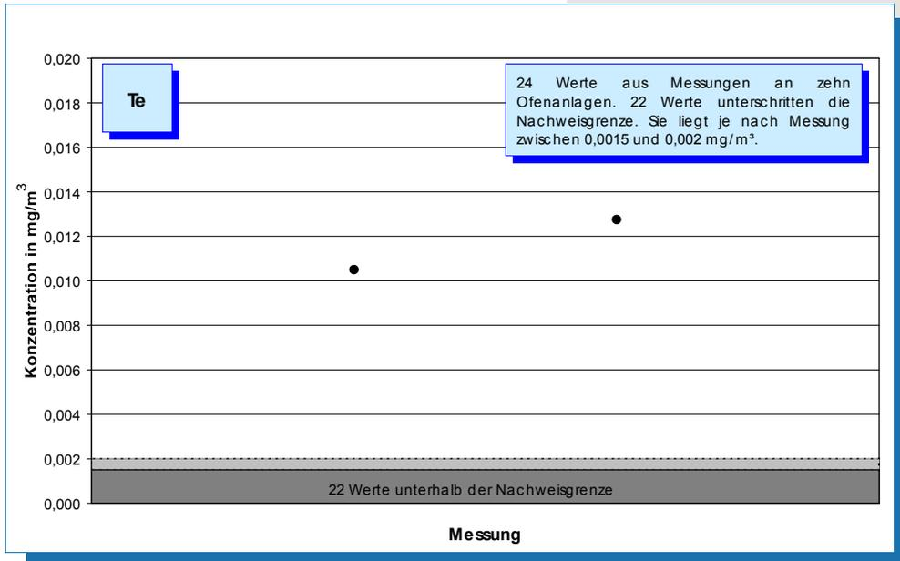
**Bild 5-55: Messwerte (Jahr 2004) der Tellur-Konzentration im Reingas von zehn Drehofenanlagen.**
