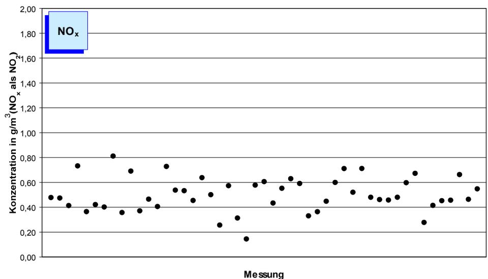
**Bild 5-3: Mittelwerte (Jahr 2004) der NO<sub>x</sub>-Konzentration im Reingas von 49 Drehofenanlagen. Anmerkung: im Jahr 2004 überstiegen die Emissionen mehrerer Anlagen die heute in der TA Luft für Zementwerke vorgesehenen Emissionswerte. Die Betriebsgenehmigungen für diese Werke beruhen noch auf höheren NO<sub>x</sub>-Grenzwerten. Einige dieser Anlagen sind bzw. werden in den nächsten Jahren stillgelegt, weitere werden mit einer Anlage zur NO<sub>x</sub>-Minderung nachgerüstet.**
