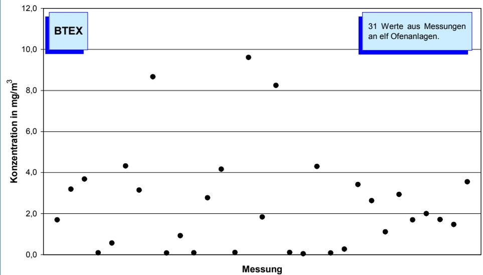
Bild 5-17: Messwerte (Jahr 2004) der Konzentration von BTEX im Reingas von 12 Drehofenanlagen. Eine Nachweisgrenze lässt sich aus der Norm nicht ableiten. Bei den eingesetzten Messverfahren sind gemessene Emissionskonzentrationen unterhalb von 0,013 mg/m<sup>3</sup> nicht abgesichert.
