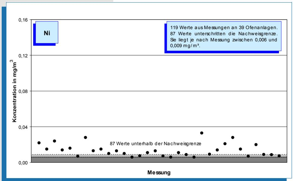
**Bild 5-45: Messwerte (Jahr 2004) der Nickel-Konzentration im Reingas von 39 Drehofenanlagen.**
