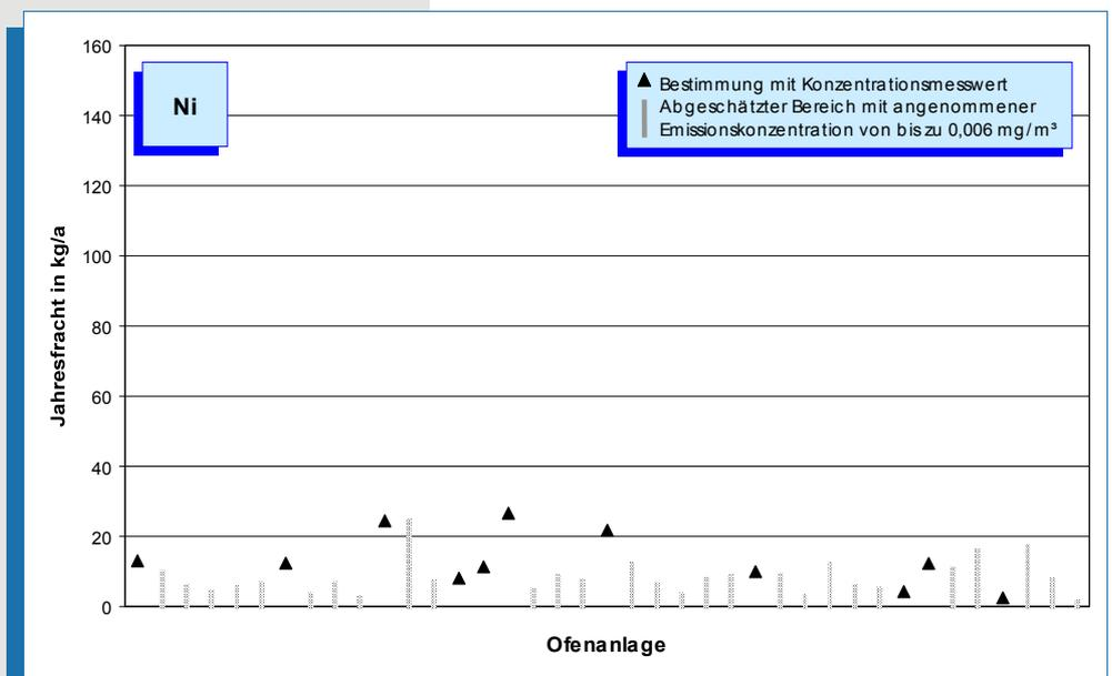
**Bild 5-46: Nickel-Emissionen (Jahresfracht 2004) von 39 Drehofenanlagen.**
