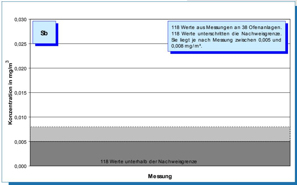
**Bild 5-31: Messwerte (Jahr 2004) der Antimon-Konzentration im Reingas von 38 Drehofenanlagen.**
