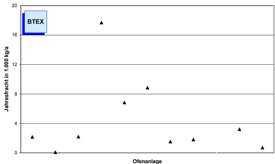
Bild 5-18: BTEX-Emissionen (Jahresfracht 2004) von 12 Drehofenanlagen.
