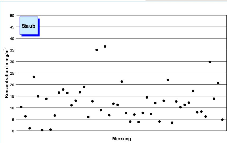
Bild 5-1: Mittelwerte (Jahr 2004) der Staubkonzentration im Reingas von 49 Drehofenanlagen.
