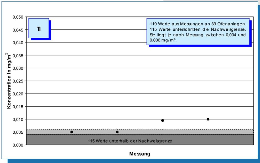
**Bild 5-27: Messwerte (Jahr 2004) der Thallium-Konzentration im Reingas von 39 Drehofenanlagen.**
