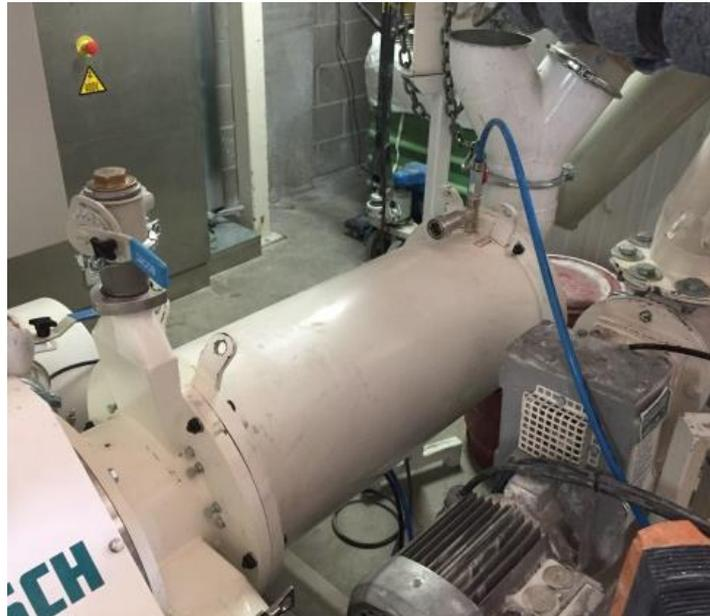
**Abbildung 1-18** Horizontale Rührwerkskugelmühle der Fa. Netzsch [TF19]
