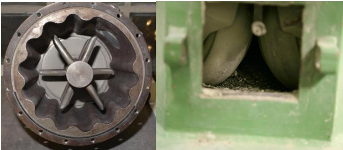
**Bild 3-1** Links: Rührwerkskugelmühle. Rechts: Mahlraum der Vertikal-Wälzmühle [Tre 2017]
