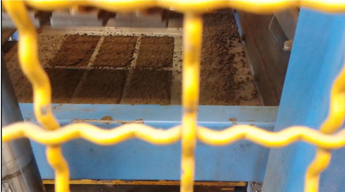
Bild 2 Vollständig befüllte Betonpflastersteinformen kurz vor dem Hauptrütteln in der Technikumsanlage (Stempel fahren soeben herunter)
