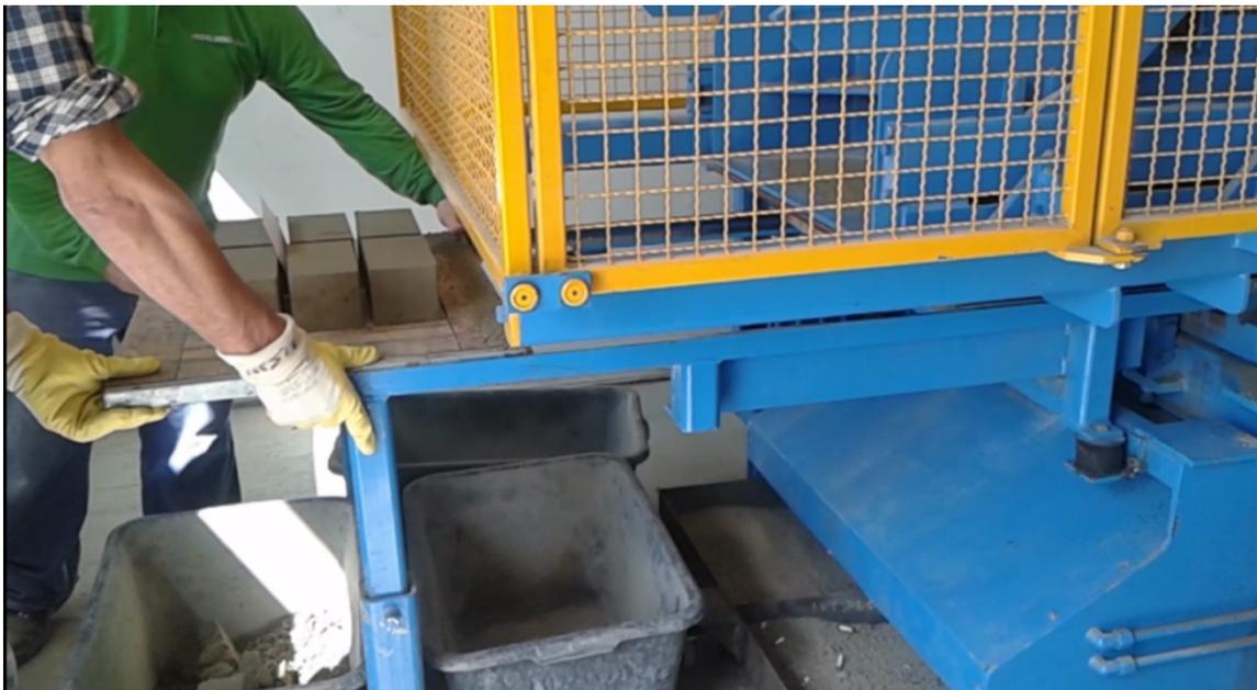
Bild 3 Entnahme der hergestellten Betonpflastersteine aus der Technikums-Anlage
