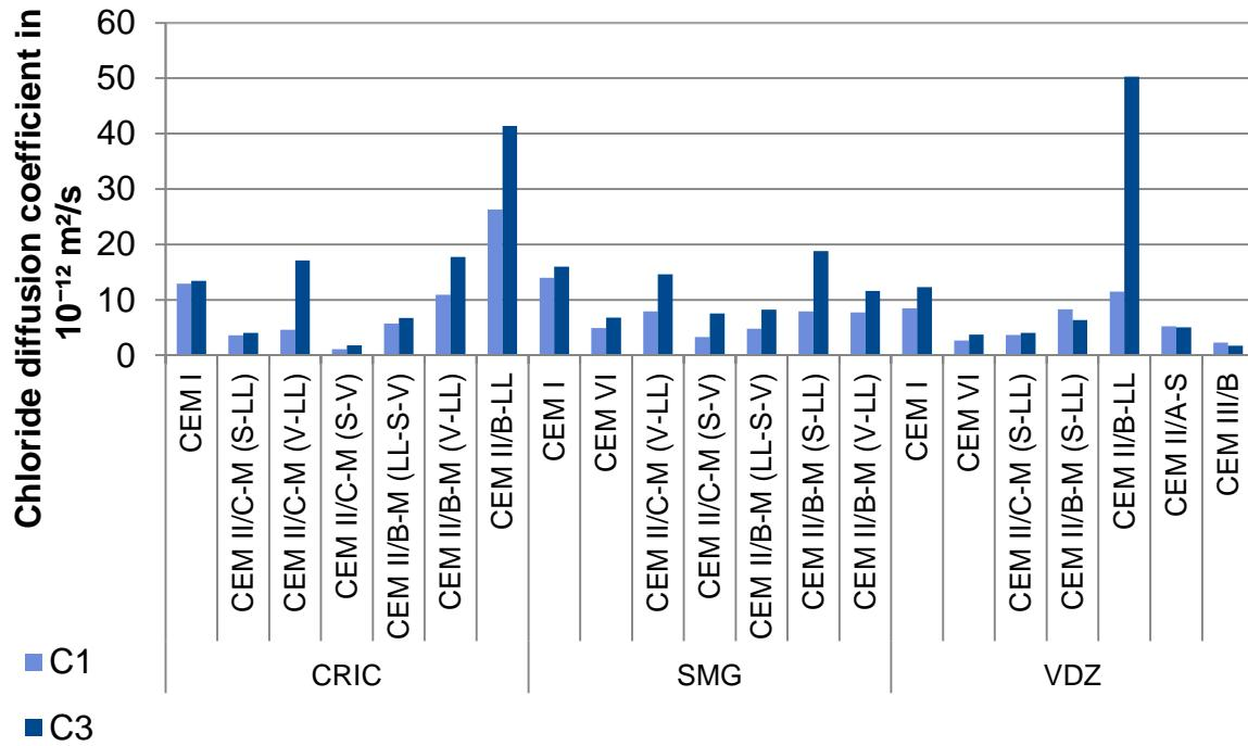
**Figure 26** Chloride diffusion coefficients
