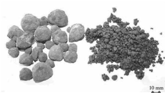
**Bild 4–13** Makroskopisches Aussehen von Werksklinker (links) und Standard-Laborklinker (rechts)
