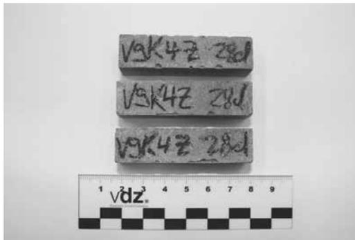
**Bild 4-19** Miniprismen für die Festigkeitsuntersuchungen
