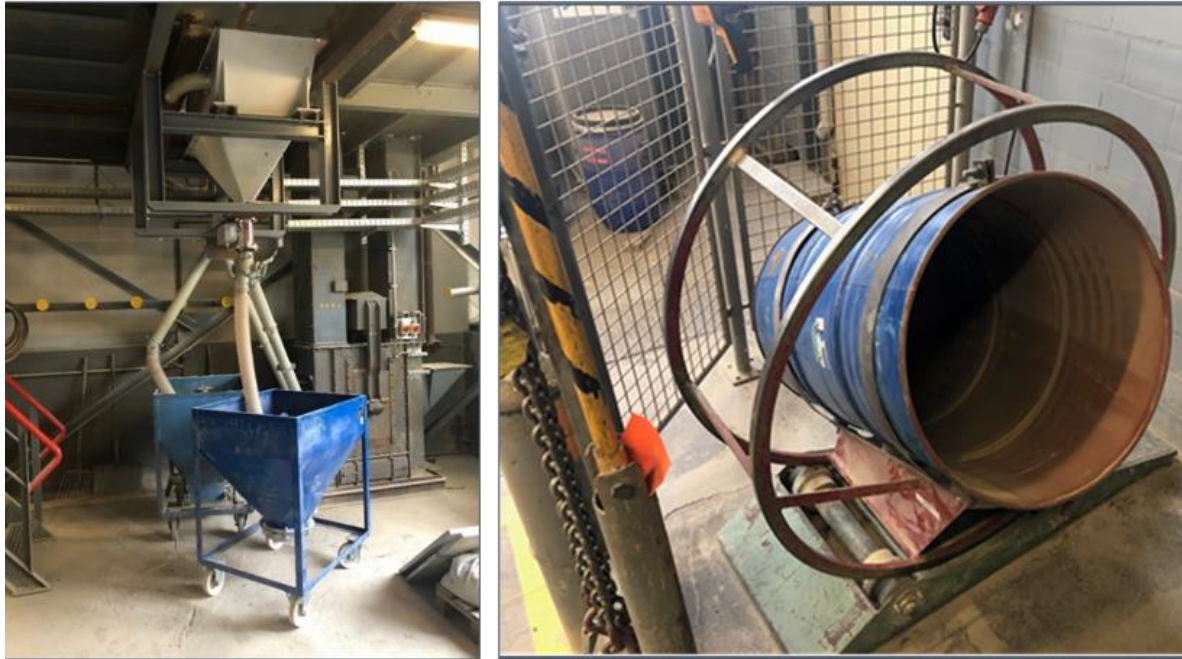
Abbildung 2-7 Probenaufbereitung. Links: Auffangbehälter für Siebdurchgang und Siebüberlauf. Rechts: Rhönrad zur Homogenisierung.
