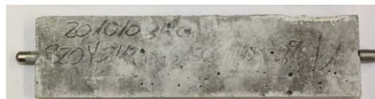
**Bild 13** Flachprisma des Typs B20Y mit 14 Tagen Vorlagerung, nach zwei Jahren Lagerung in S1500/160 bei 8 °C
