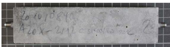
**Bild 16** Flachprisma des Typs A20X nach zwei Jahren Lagerung in S1500/160 bei 20 °C
