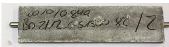
**Bild 5** Flachprisma des Typs B0 nach zwei Jahren Lagerung in S1500/0 bei 8 °C
