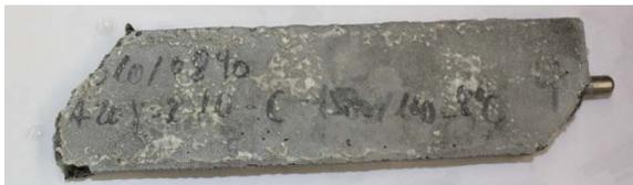
**Bild 10** Flachprisma des Typs A20Y mit 2 Tagen Vorlagerung, nach zwei Jahren Lagerung in S1500/160 bei 8 °C
