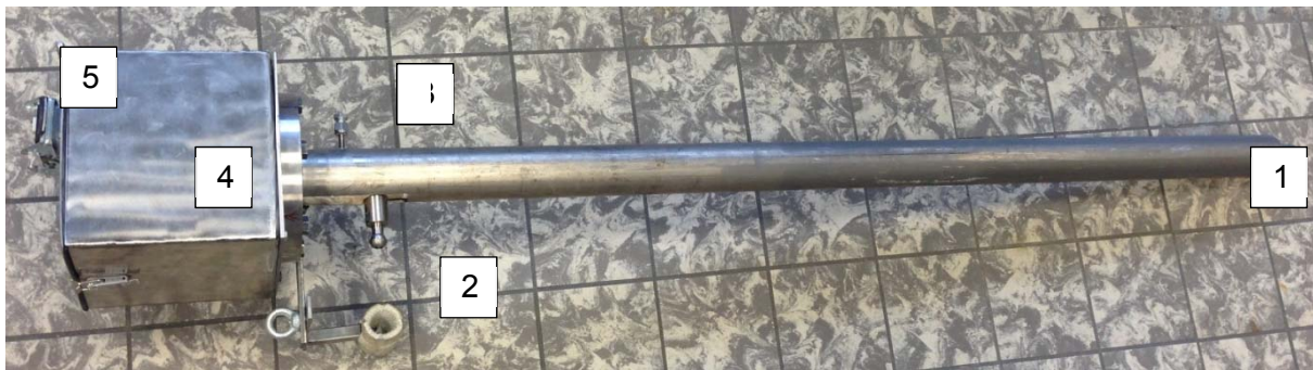
Bild 4-1 Messsonde der HDTP300; 1: Sondenspitze (Gaseintritt), 2: Gasausgang A (nasschemische Gasmessungen), 3: Gasausgang B (kontinuierliche Gasmessungen), 4: beheizter Sondenkopf, 5: Anschlüsse zum Schaltkasten
