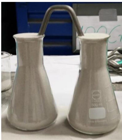
Bild 7 Referenzmessung mittels Volumenverdrängung für einen der Anker
