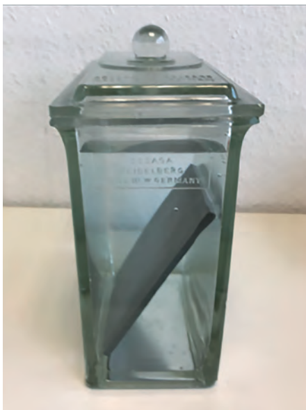
Bild 6: Carbonbetonprobekörper im Standtest in Anlehnung an CEN/TS 16637-2
