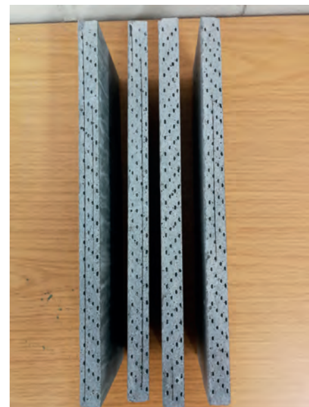
Bild 13: Verteilung der Carbontextilbewehrung in der Feinbetonplatte L 4-2 B
