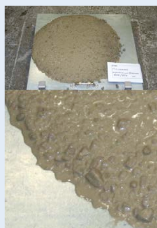
Ausbreitkuchen des Betons mit 370 kg/m³ Mehlkorngelalt (Sieblinie S3) Concrete flow table pat containing 370 kg/m³ flour-fines (grading curve S3)
