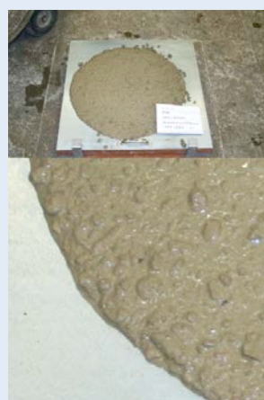
Ausbreitkuchen des Betons mit 380 kg/m³ Mehlkorngelalt (Sieblinie S5) Concrete flow table pat containing 380 kg/m³ flour-fines (grading curve S5)
