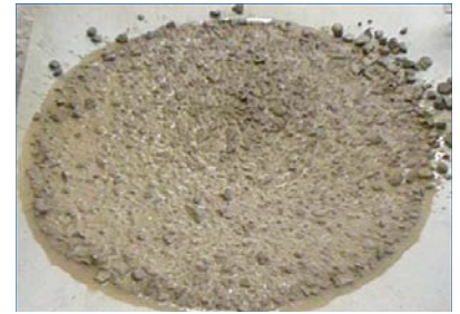
Bild 2: Entmischungserscheinungen bei einem Beton mit einem Leimgehalt von ca. 260 l/m³ (siehe Kennzeichnung in Bild 1)
