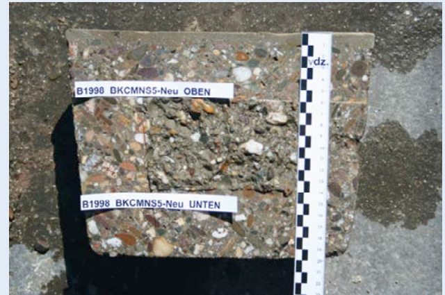
Bild 9: Prüfkörper zur Beurteilung der Stabilität im erhärteten Zustand und zur Bestimmung der Porosität im Alter von 28 Tagen. z = 340 kg/m 3 ; Zement CEM II/A-LL 32,5 R; MNS: 1,4 M.-% v.z.; Sieblinie S1
