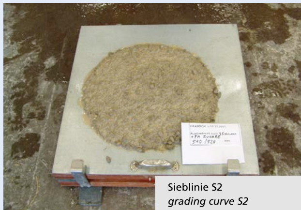
Bild 4: Einfluss der Gesteinskörnungszusammensetzung, insbesondere der Korngruppe 0/0,125, auf die Wasser- und Zementleimrandbildung des Betons im Ausbreitversuch
