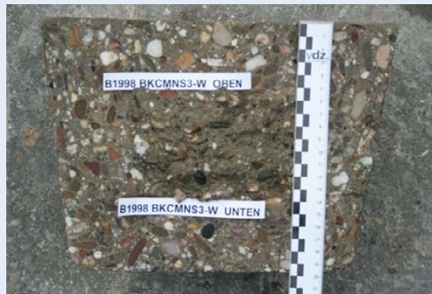
Bild 9: Prüfkörper zur Beurteilung der Stabilität im erhärteten Zustand und zur Bestimmung der Porosität im Alter von 28 Tagen. z = 340 kg/m 3 ; Zement CEM II/A-LL 32,5 R; MNS: 1,4 M.-% v.z.; Sieblinie S1
