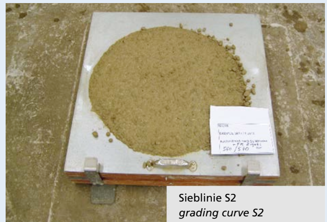
Bild 4: Einfluss der Gesteinskörnungszusammensetzung, insbesondere der Korngruppe 0/0,125, auf die Wasser- und Zementleimrandbildung des Betons im Ausbreitversuch
