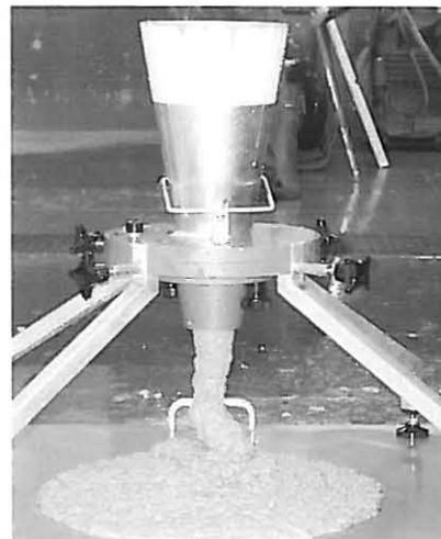
**Bild 10:** Ermittlung der Auslaufzeit und des Setzfließmaßes für SVB 6 mit dem Auslaufkegel und montierter 60-mm-Auslaufdüse
