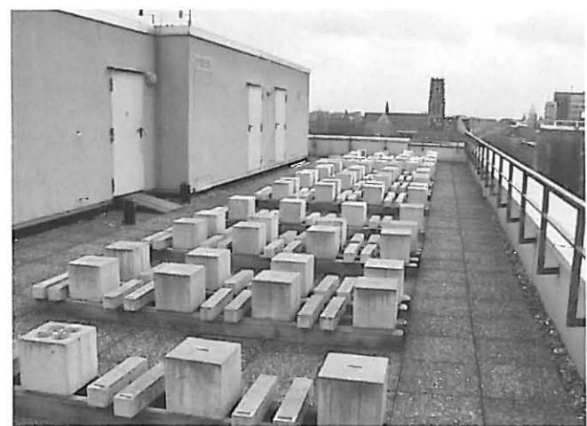
Bild 1: Balken und Würfel im Außenlager des Forschungsinstitutes in Düsseldorf
