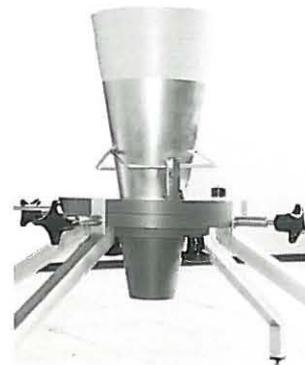
**Bild 7: Montierter Auslaufkegel mit 50-mm-Auslaufdüse**
