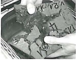
**Bild 3:** CIF-Platte mit  $(w/z)_{eq}$  0,45 und 8 M.-% Silikastaub nach 56 Frost-Tau-Wechseln
