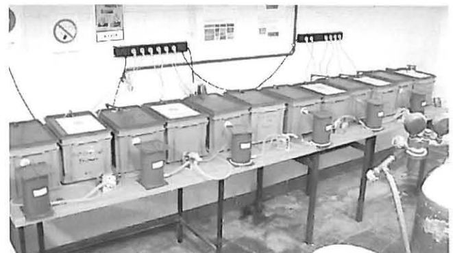
Bild 2: pHstat-Versuchsaufbau mit Säure/Base-Puffersystem Figure 2: pHstat test set-up with acid/base buffer system
