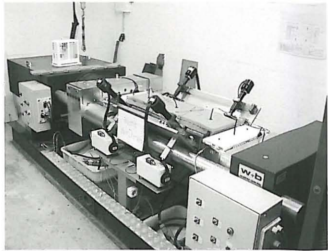
Bild 3: Temperatur-Spannungsprüfmaschine Figure 3: Temperature-Stress testing machine – Test set-up
