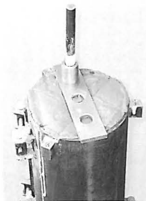
Bild 6: Tauchstabversuch: Tauchstab ist vollständig bis zur Markierung durch Führungsrohr in mit SVB gefülltem Probekörper (Zylinder \varnothing = 150 mm, h = 600 mm) abgesunken
