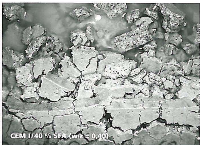
Bild 6: Mörtelflachprismen aus Portlandzement und Portlandzement/Flugasche-Gemisch (w/z = 0,40) nach 180 Tagen Lagerung in Natriumsulfatlösung (29 800 mg Sulfat/l), Lagerungstemperatur 8 °C
