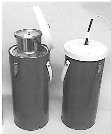
Bild 2: Hydratationswärmebestimmung Figure 2: Heat of Hydration – Test set-up
