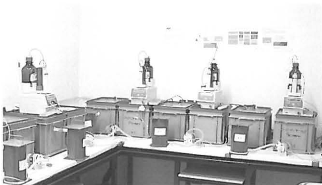
Bild 1: pHstat-Versuchsaufbau mit kontinuierlicher Endpunkttitration Figure 1: pHstat test set-up with permanent titration
