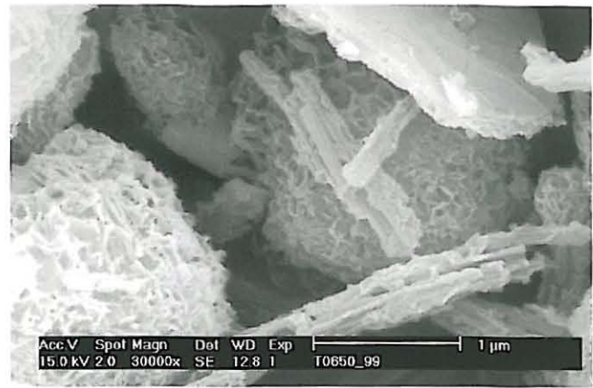
Bild 2: Restwasserfeststoff 30 000fach vergrößert: links unmittelbar nach dem Auswaschvorgang und rechts nach rd. 72-stündiger Lagerung im Restwasserbehälter
