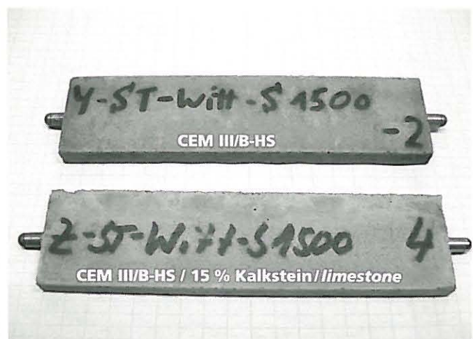
Bild 8: Mörtelflachprismen aus HS-Zement und HS-Zement/Kalksteinmehl-Gemischen ( w/z = 0,60 ) nach zwei Jahren Lagerung in Natriumsulfatlösung (1500 mg Sulfat/l), Lagerungstemperatur 8 °C
