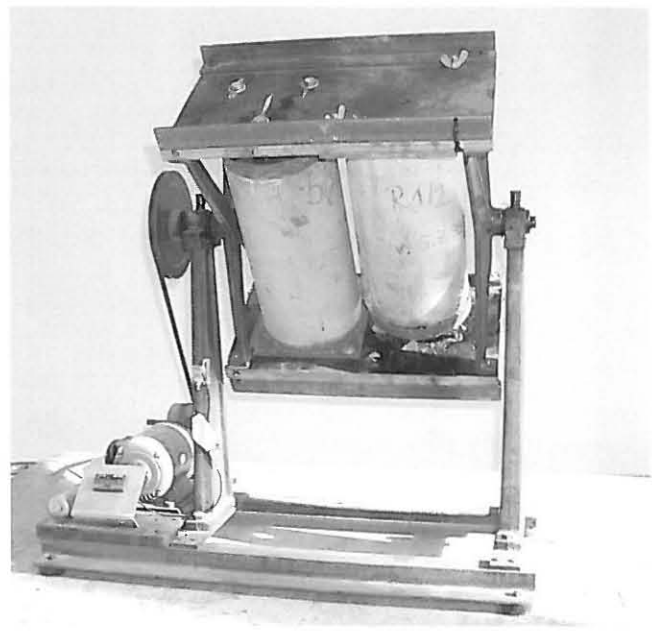
Bild 6: Prüfapparatur zur Simulation der Kanalbedingungen mit abrasiver Beanspruchung
