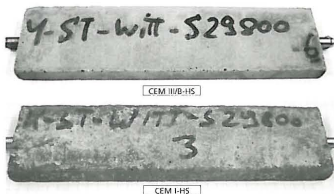
Bild 3: Mörtelflachprismen ( w/z = 0,60 ) nach 2 Jahren Lagerung in Natriumsulfatlösung (29 800 mg Sulfat/l), Lagertemperatur 8 °C Figure 3: Flat mortar prisms [ w/z = 0,60 ] after 2 years storage in sodium sulfate solution (29 800 mg sulfate/l), storage temperature 8 °C
