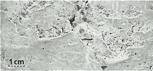
**Bild 7:** Oberflächenstruktur eines in glatter Schalung verdichteten Rüttelbetons mit zu geringem Mehlkorngelalt und zu hoher Fließmitteldosierung
