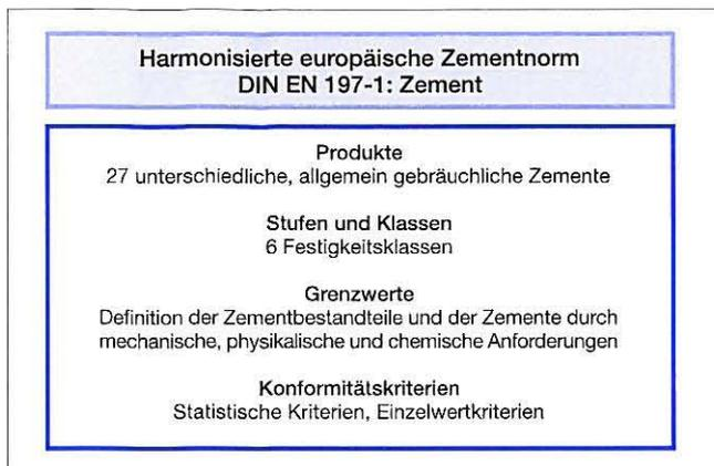
**Bild 2: Harmonisierte europäische Zementnorm DIN EN 197-1
