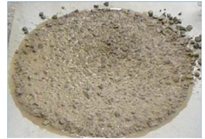
Bild 2: Entmischungerscheinungen bei einem Beton mit einem Leimgehalt von ca. 260 l/m 3 (siehe Kennzeichnung in Bild 1)
