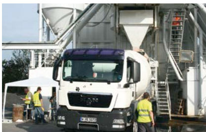
Bild 2: a) Übersicht über Mischanlage, Fahrmischer und Baustellenlabor; b) Ablassen von Frischbeton nach definierten Mischzeiten in den Fahrmischer; c) Ablassen des Frischbetons aus dem Fahrmischer in Mörtelwannen Figure 2: a) General view of mixing plant, truck mixer and site laboratory; b) unloading fresh concrete into the truck mixer after a specified mixing time; c) unloading the fresh concrete from the truck mixer into mortar pans
