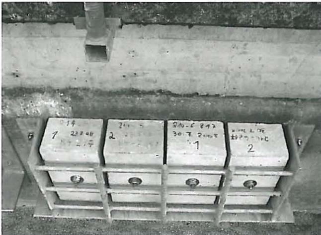
Bild 18: Auslagerungsstelle für die Betone B4 ( $w/z = 0,50$  und  $z = 320 \text{ kg/m}^3$ ) an der Schleuse Hilpoltstein [16] bei hoher Wassersättigung ohne Taumittel
