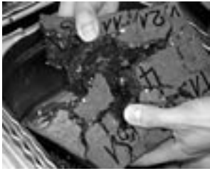
Bild 3: CIF-Platte mit (w/z) eq 0,45 und 8 M.-% Silikastaub nach 56 Frost-Tau-Wechseln Figure 3: CIF slab with (w/z) eq of 0.45 and 8 mass % silica fume after 56 freeze-thaw cycles
