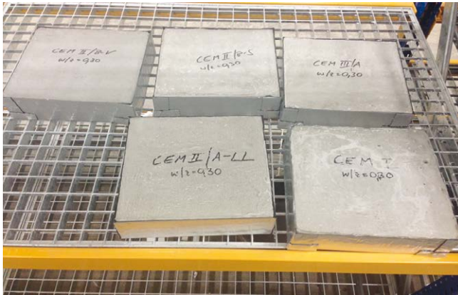
Bild 7: Probekörper mit den Abmessungen 20 cm x 20 cm x 6 cm aus Zementstein Figure 7: 20 cm x 20 cm x 6 cm test specimens made of hardened cement paste
