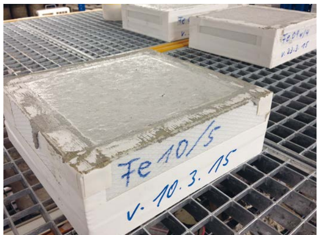
Bild 1: Probekörper 30 cm x 30 cm x 6 cm zur Untersuchung des Trocknungsverhaltens von Zementestrich Figure 1: 30 cm x 30 cm x 6 cm test pieces for investigating the drying behaviour of cement screed
