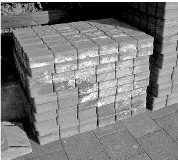
Bild 1: Ausblühungen an paketierten Pflastersteinen
