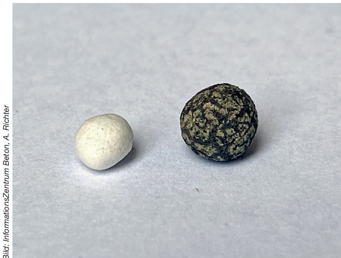
Bild 2: Beispiele für leichte Gesteinskörnungen; Blähglas (links) und Blähton (rechts)
