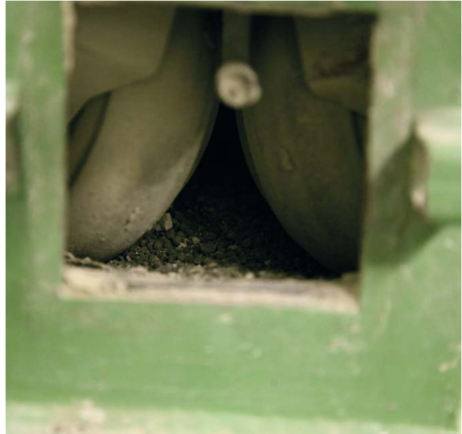
Bild 3.1.1-2 Mahlraum der kleintechnischen Vertikal-Wälzmühle
