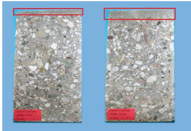
Bild 3.4.15-2 Gefüge eines niedrigviskosen LVB nach Verdichtung mittels Rakeln (links) bzw. nach Verdichtung auf dem Rütteltisch ( f = 50 \text{ Hz} ) für jeweils 20 Sekunden in drei Lagen (rechts); markierte Bereiche: Sichtbare Sedimentation der groben Gesteinskörnung
