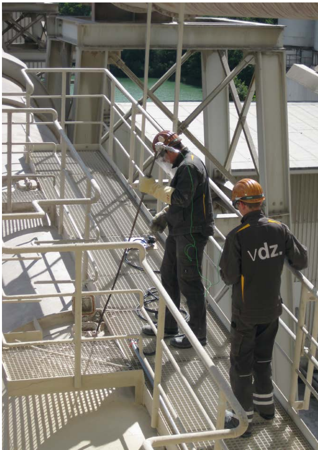
Bild 3.1.3-2 Messung der Heißgastemperatur bei einer Betriebsmessung
