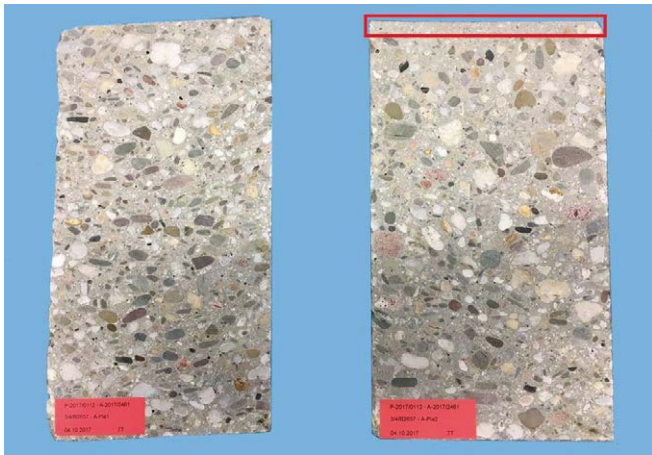
Bild 3.4.15-1 Gefüge eines mittelviskosen LVB nach Verdichtung mittels Rakeln (links) bzw. nach Verdichtung auf dem Rütteltisch ( f = 50 \text{ Hz} ) für jeweils 20 Sekunden in drei Lagen (rechts); markierter Bereich: Sichtbare Sedimentation der groben Gesteinskörnung
