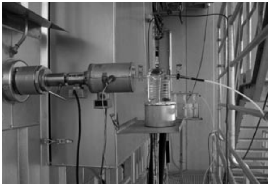
Bild I-7: \text{SO}_3 -Messung im Reingas einer Zementofendrehanlage nach der VDI-Richtlinie 2462 Blatt 2 (Stand 2010)
