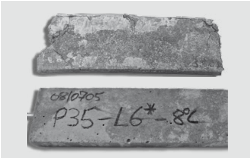
Bild V-37: Mörtelfachprismen auf Basis von Portlandzement mit 20 M.-% Steinkohlenflugasche (oben) und 30 M.-% Steinkohlenflugasche (unten) nach rd. 10 Monaten Lagerung bei 8 °C in Natriumsulfatlösung (S1500) mit 160 mg Magnesium, 14 Tage Vorlagerung, DAfStb-Forschungsprojekt
