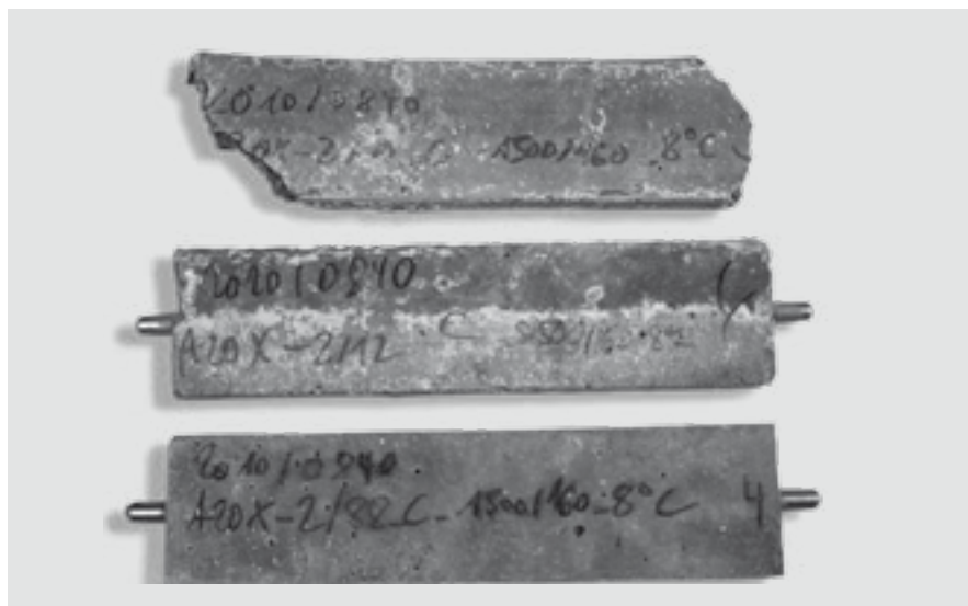
Bild V-40: Mörtelflachprismen auf Basis von Portlandzement mit 20 M.-% Steinkohlenflugasche, 12 Monate gelagert bei 8 °C in Natriumsulfatlösung (S1500) mit 160 mg Magnesium nach 2 Tagen Vorlagerung (Prisma oben), 14 Tagen Vorlagerung (Prisma Mitte) und 90 Tagen Vorlagerung (Prisma unten), AiF-Forschungsprojekt
