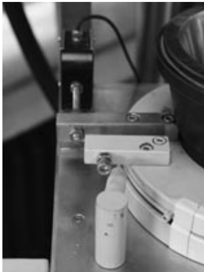
Bild I-14: Modifizierte Messung der Leistung mittels Kraftmessdose
