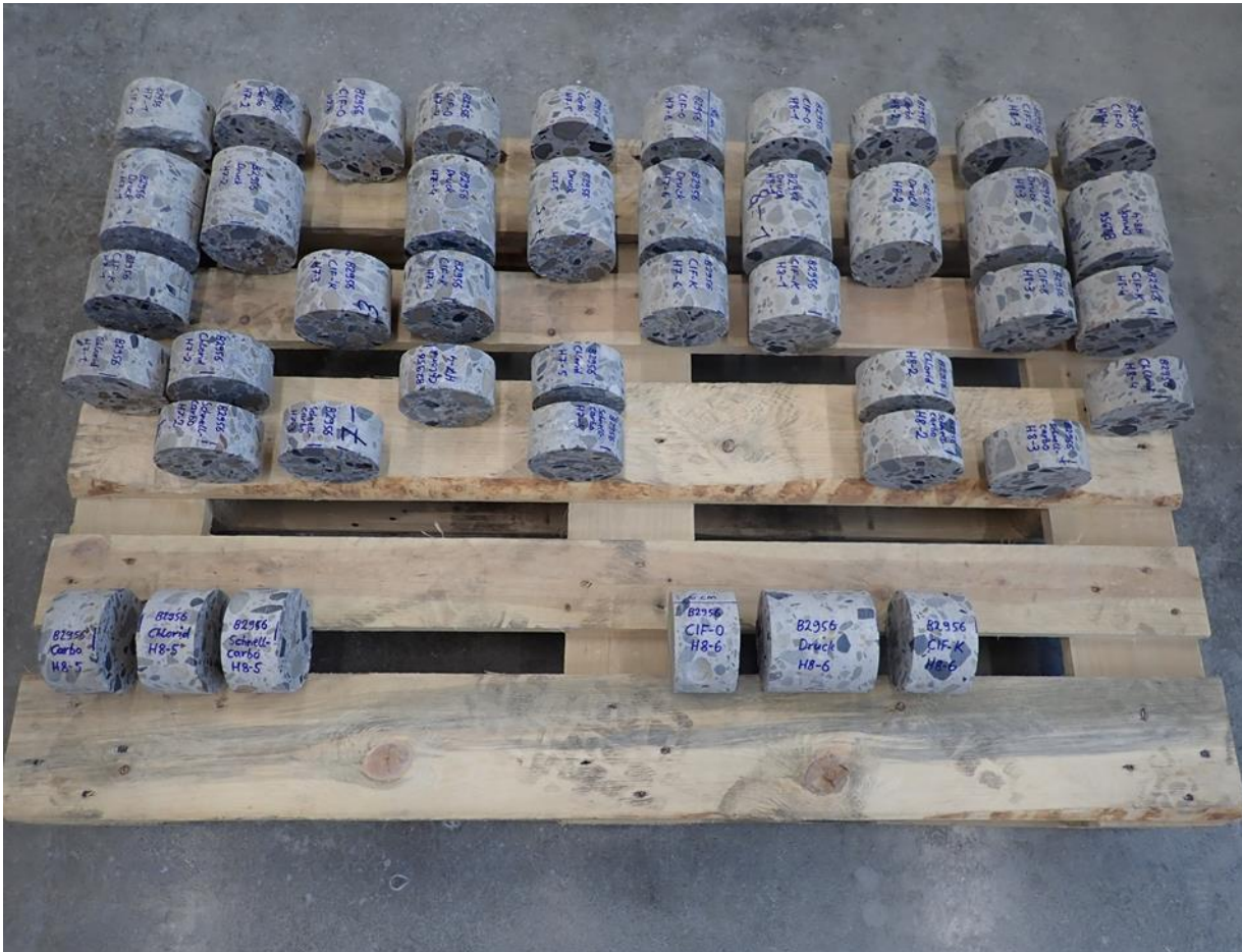
Bild 70 Zugeschnittene Bohrkernabschnitte der Hochbauten 1 und 2
