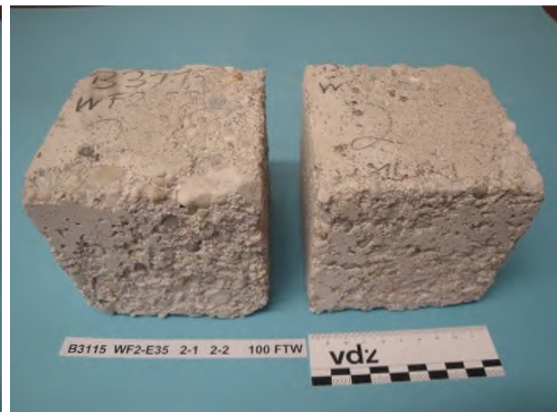
Bild 7-38 Beton WF2-E35 – CEM VI (S2-LL2), 1 FTW/Tag, Würfel 3 und 4 nach 100 FTW im Würfelverfahren
