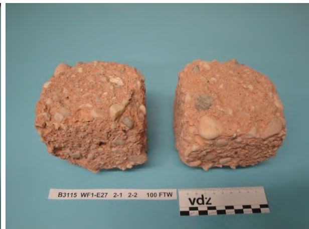
Bild 7-14 Beton WF1-E27 – CEM II/C-M (Q3-LL2), 1 FTW/Tag, Würfel 3 und 4 nach 98 FTW im Würfelverfahren
