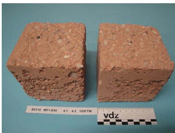
Bild 7-32 Beton WF1-E45 – CEM VI (S1-Q3), 2 FTW/Tag, Würfel 3 und 4 nach 100 FTW im Würfelverfahren
