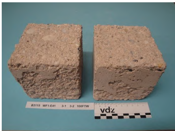
Bild 7-27 Beton WF1-E41 – CEM VI (S1-Q2), 2 FTW/Tag, Würfel 1 und 2 nach 100 FTW im Würfelverfahren
