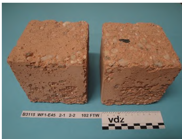
Bild 7-30 Beton WF1-E45 – CEM VI (S1-Q3), 1 FTW/Tag, Würfel 3 und 4 nach 102 FTW im Würfelverfahren
