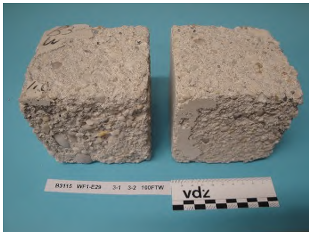
Bild 7-19 Beton WF1-E29 – CEM VI (S1-LL1), 2 FTW/Tag, Würfel 1 und 2 nach 100 FTW im Würfelverfahren
