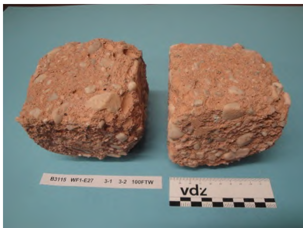
Bild 7-15 Beton WF1-E27 – CEM II/C-M (Q3-LL2), 2 FTW/Tag, Würfel 1 und 2 nach 100 FTW im Würfelverfahren
