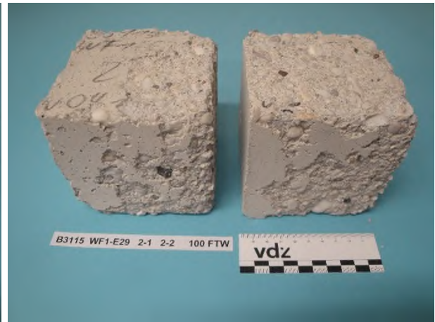
Bild 7-18 Beton WF1-E29 – CEM VI (S1-LL1), 1 FTW/Tag, Würfel 3 und 4 nach 100 FTW im Würfelverfahren
