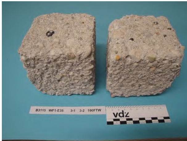
Bild 7-23 Beton WF1-E35 – CEM VI (S2-LL2), 2 FTW/Tag, Würfel 1 und 2 nach 100 FTW im Würfelverfahren
