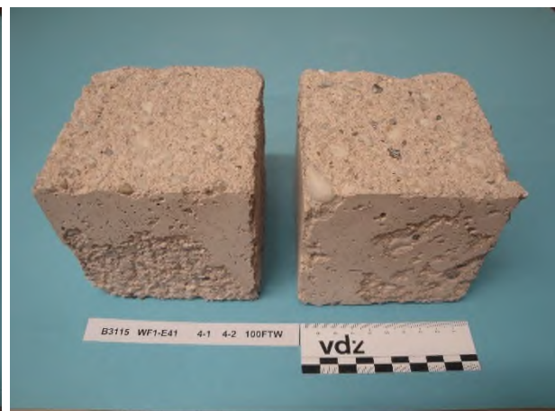
Bild 7-28 Beton WF1-E41 – CEM VI (S1-Q2), 2 FTW/Tag, Würfel 3 und 4 nach 100 FTW im Würfelverfahren
