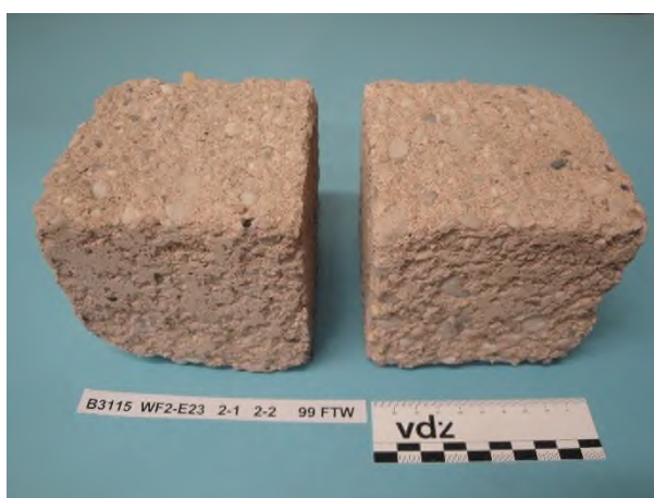
Bild 7-34 Beton WF-E23 – CEM II/C-M (Q1-LL2), 1 FTW/Tag, Würfel 3 und 4 nach 99 FTW im Würfelverfahren
