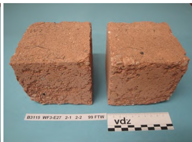
Bild 7-40 Beton WF3-E27 – CEM II/C-M (Q3-LL2), 1 FTW/Tag, Würfel 3 und 4 nach 99 FTW im Würfelverfahren
