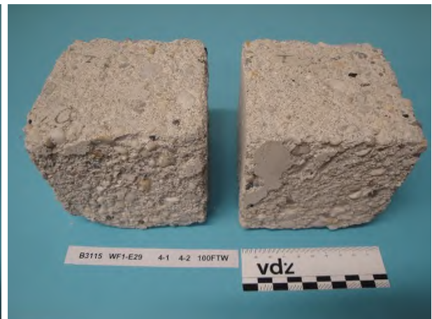
Bild 7-20 Beton WF1-E29 – CEM VI (S1-LL1), 2 FTW/Tag, Würfel 3 und 4 nach 100 FTW im Würfelverfahren
