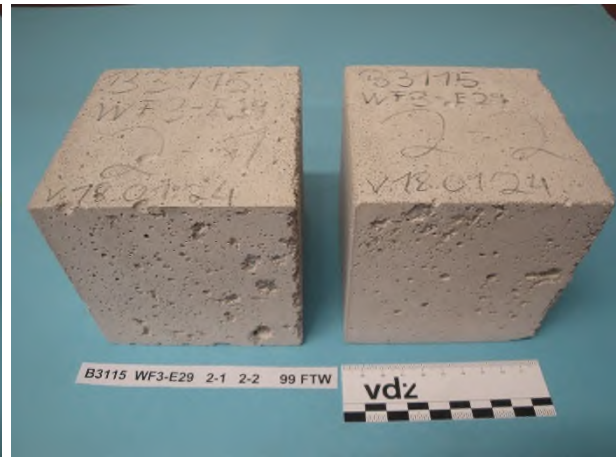
Bild 7-42 Beton WF3-E29 – CEM VI (S1-LL1), 1 FTW/Tag, Würfel 3 und 4 nach 99 FTW im Würfelverfahren
