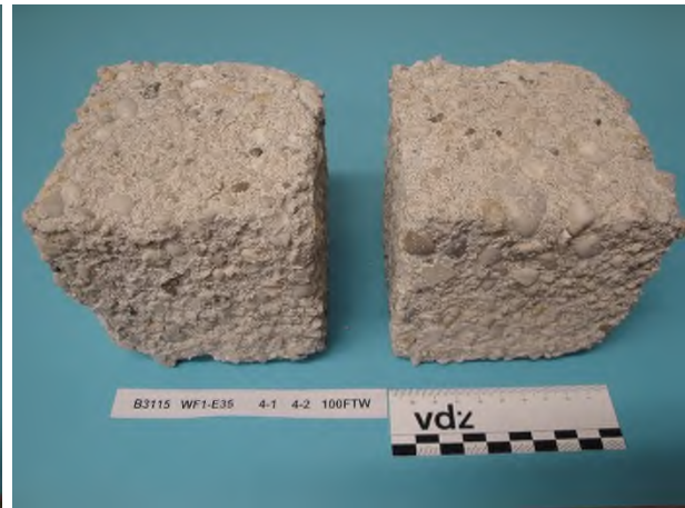
Bild 7-24 Beton WF1-E35 – CEM VI (S2-LL2), 2 FTW/Tag, Würfel 3 und 4 nach 100 FTW im Würfelverfahren
