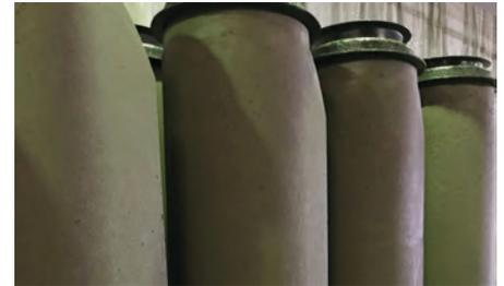
Bild 1: Anwendung des Versuchs zement aus gemeinsamer Mahlung in der Fertigung von Betonrohren. Quelle: Betonwerk Bieren
