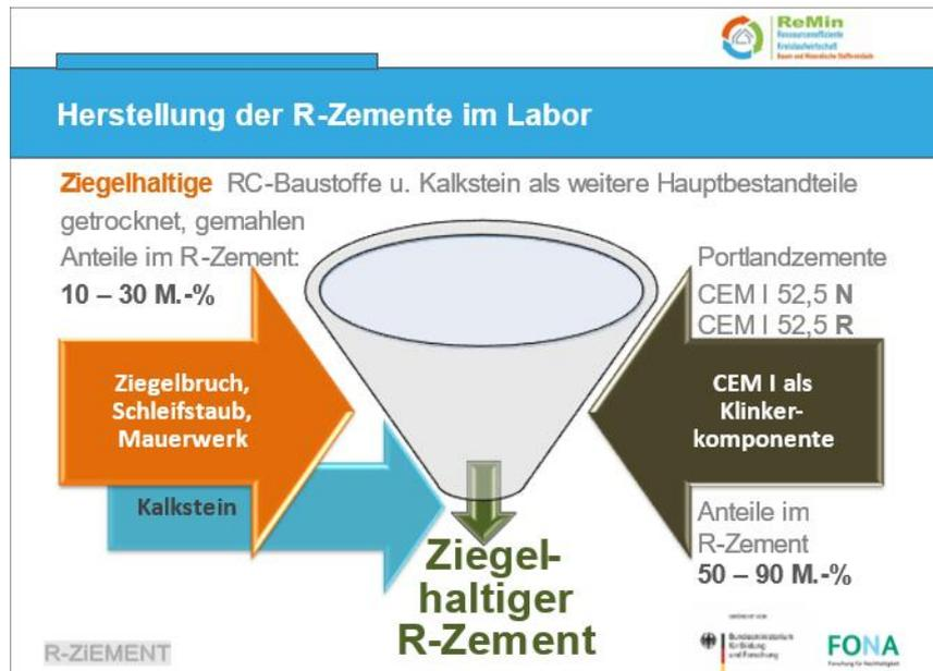
**Bild 33** Prinzip der Herstellung der Versuchszemente: Beispiel getrenntes Mahlen und anschließendes Mischen im Labor, Quelle: ReMin-Statuskonferenz
