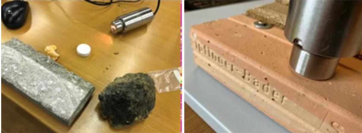
**Bild 6** NIR-Sensor mit verschiedenen Proben (links). NIR-Sensor beim Vermessen eines Ziegels (rechts)
