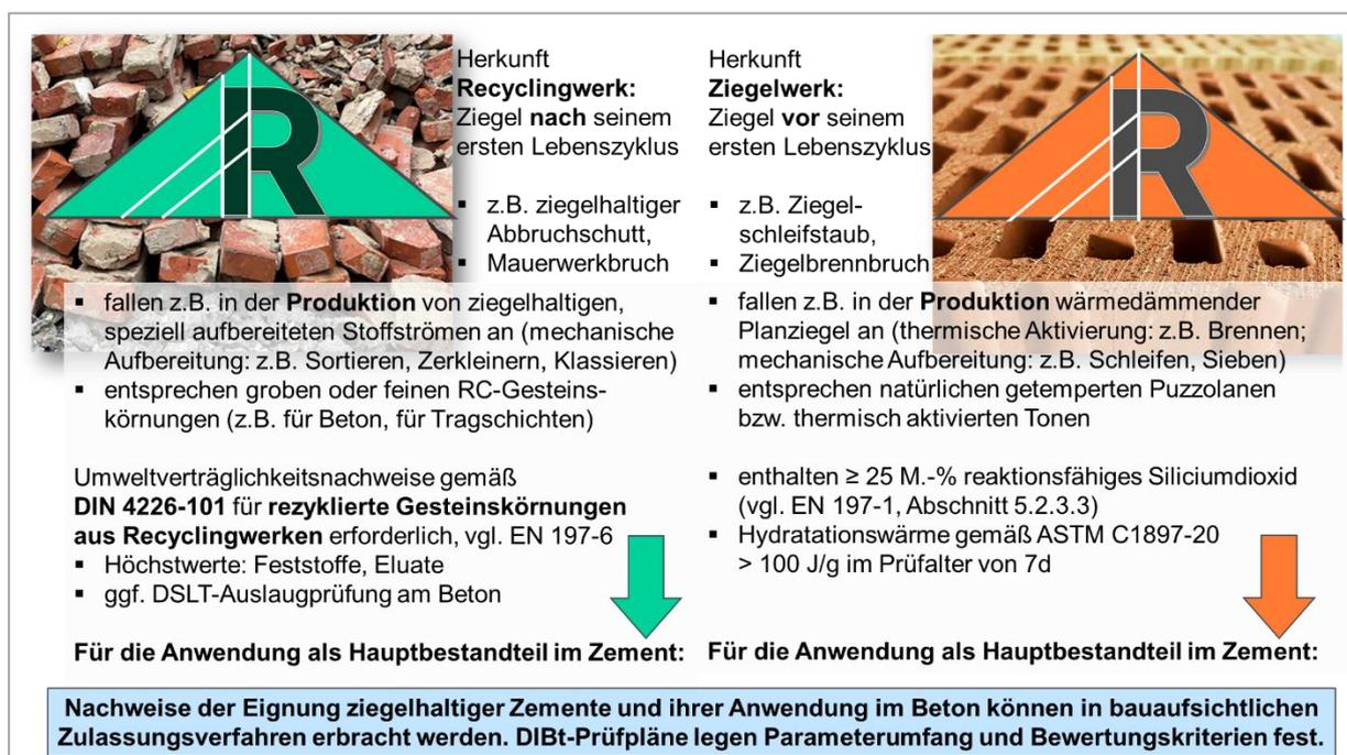
**Bild 97** Stoffströme aus den Recyclingwerken (links) und aus den Ziegelwerken (rechts), Verwertungspotenziale als Hauptbestandteil im Zement
