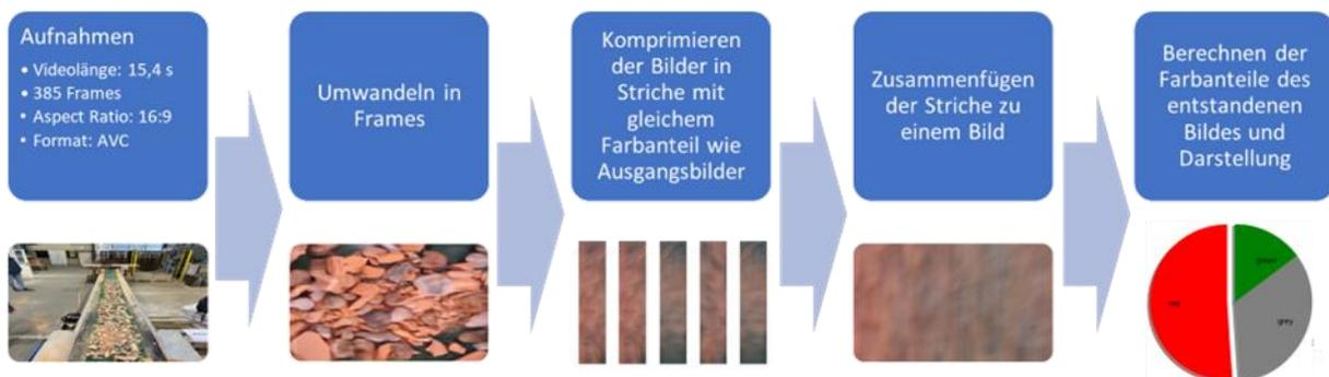
**Bild 8** Workflow zur Bestimmung der Farbanteile im Ziegelbruch
