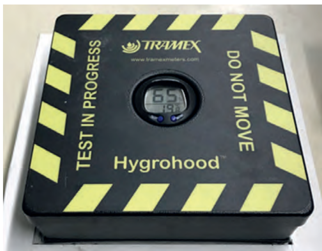
Bild 4: Bestimmung der relativen Feuchte an der Estrichoberfläche
