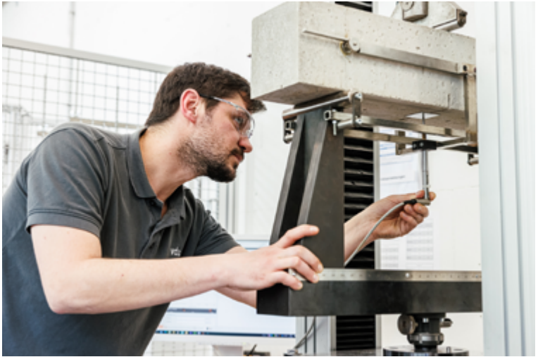
Neben Standardprüfverfahren ist unser Labor auch akkreditiert für Biegezugprüfungen von Stahlfaserbeton nach DIN EN 14651 2007-12
