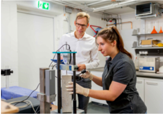
Messung der Längenänderung von Betonprismen im VDZ-Labor
