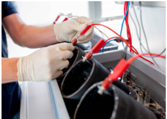
Laboruntersuchung zum Chlorideindringwiderstand – einem der wichtigsten Dauerhaftigkeitsparameter
