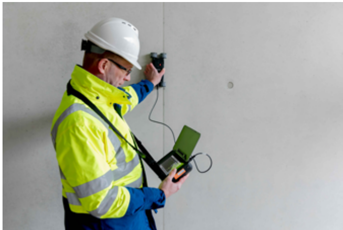
Messung der Betondeckung zur Abschätzung der Restlebensdauer
