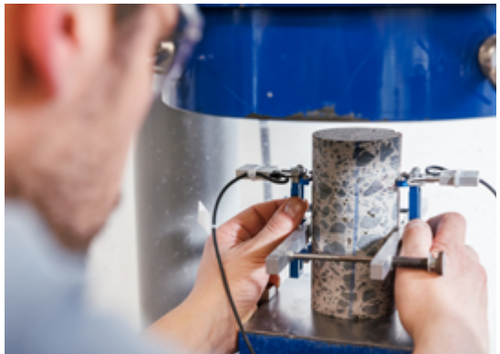
Messung des statischen Elastizitätsmoduls zur Qualitätskontrolle und Optimierung bestehender Anwendungen, z. B. bei Brücken
