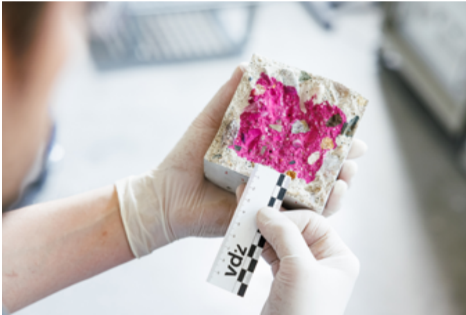
Bestimmung des Karbonatisierungswiderstandes. Nicht verfärbte Flächen weisen auf einen karbonatisierten Beton hin
