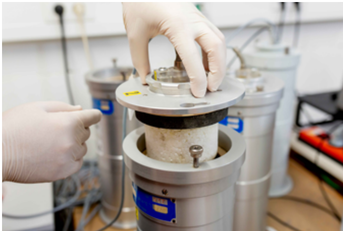
Bestimmung der Hydrationswärme – eine wichtige Eigenschaft bei massigen Bauteilen
