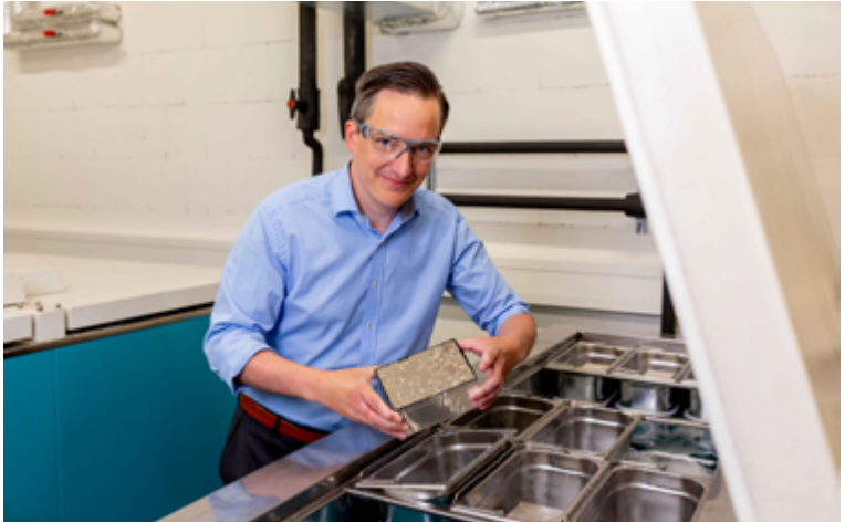
Prüfung des Frost-Tausalz-Widerstands von Beton im VDZ-Labor
