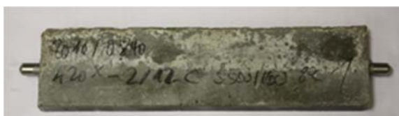
Bild 14 Flachprisma des Typs A20X nach zwei Jahren Lagerung in S1500/160 bei 8 °C
