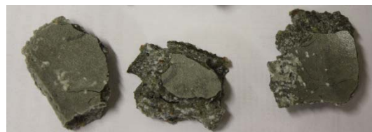
Bild 11 Flachprisma des Typs B20Y mit 2 Tagen Vorlagerung, nach zwei Jahren Lagerung in S1500/160 bei 8 °C
