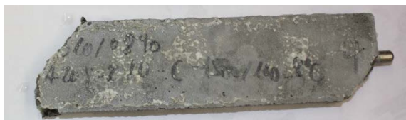
Bild 10 Flachprisma des Typs A20Y mit 2 Tagen Vorlagerung, nach zwei Jahren Lagerung in S1500/160 bei 8 °C
