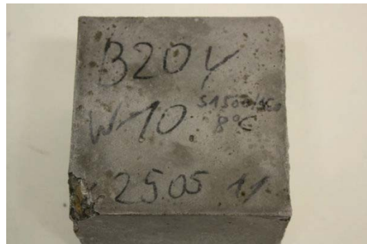
Bild 24 CEM II/A-LL mit 20 M.-% SFA Y, 2 Jahre Lagerung bei 8 °C in S1500/160
