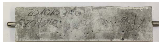
Bild 13 Flachprisma des Typs B20Y mit 14 Tagen Vorlagerung, nach zwei Jahren Lagerung in S1500/160 bei 8 °C
