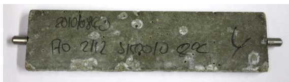
Bild 3 Flachprisma des Typs A0 nach zwei Jahren Lagerung in S1500/0 bei 8 °C
