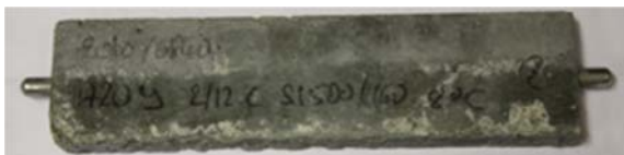
Bild 12 Flachprisma des Typs A20Y mit 14 Tagen Vorlagerung, nach zwei Jahren Lagerung in S1500/160 bei 8 °C
