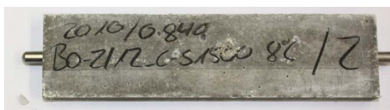
Bild 3 Flachprisma des Typs A0 nach zwei Jahren Lagerung in S1500/0 bei 8 °C
