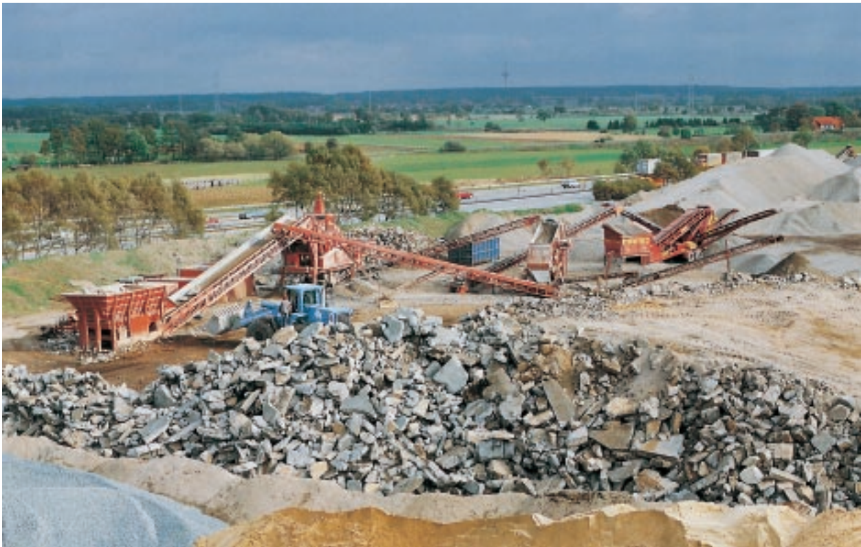
Bild 1: Aufbereitungsanlage für Betonstraßenaufbruch und verfestigte Teersande zur Wiederverwendung im Deckenbeton bzw. der hydraulisch gebundenen Tragschicht
