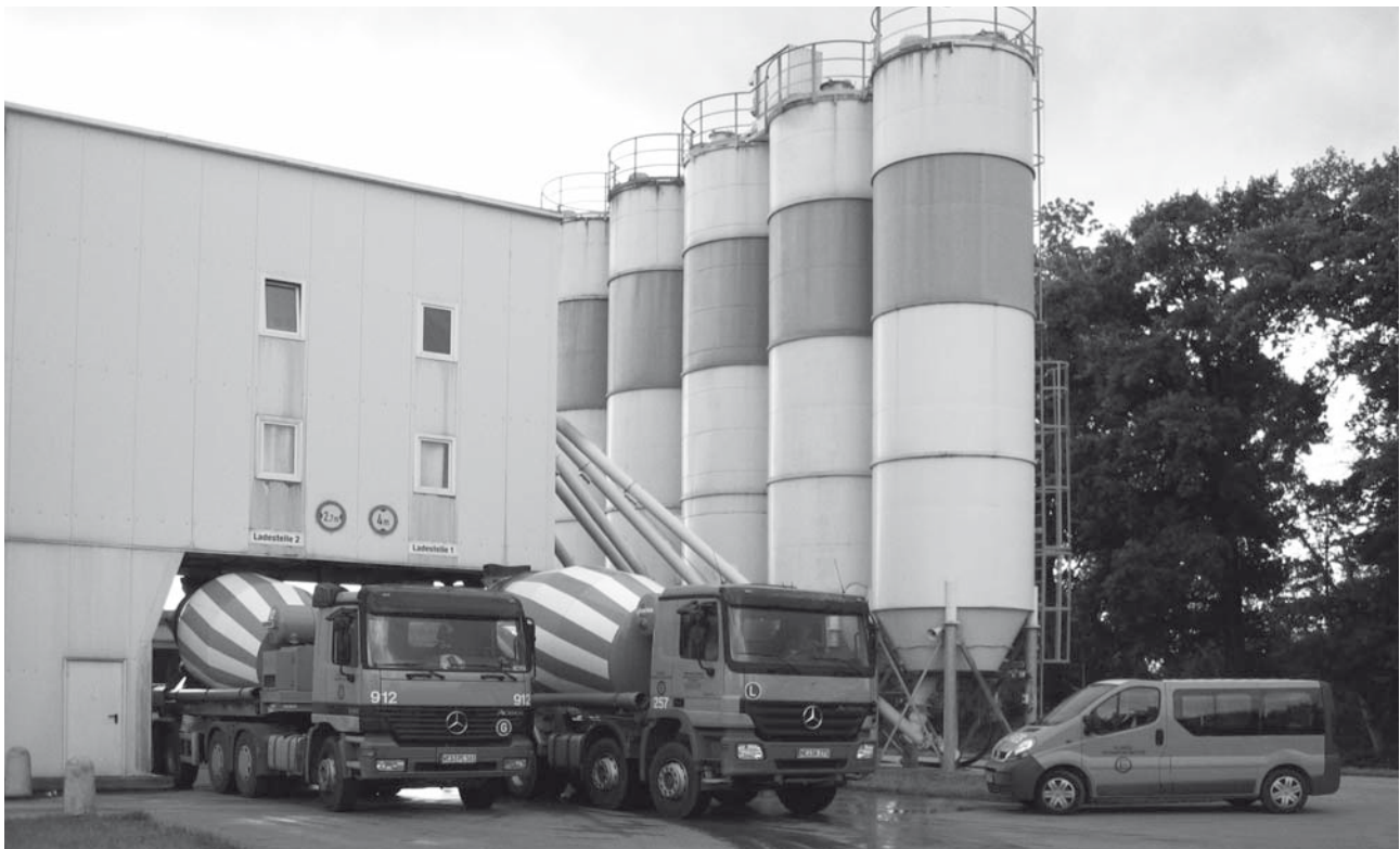
Bild 1: Lieferung von Transportbeton mit dem Fahrmischer
