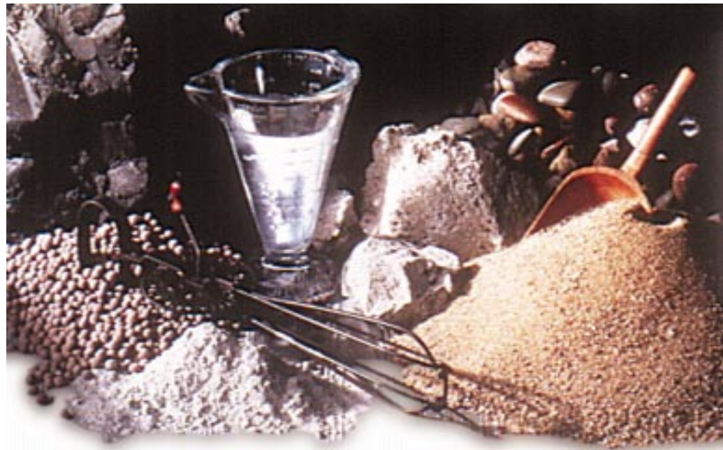
Abb. 4: Ausgangsstoffe für die Zementherstellung
