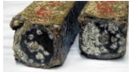
Bild 2: Bild eines geschädigten Betonprüfkörpers (Normprisma) aus Portlandzement mit Kalksteinsplitt als Zuschlag nach 400 Tagen Lagerung in sulfathaltiger Lösung (29800 mg SO 4 /l) bei 8 °C
