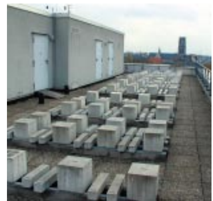
Bild 1: Praxisnahe Lagerung von Betonprobekörpern im Außenlager
