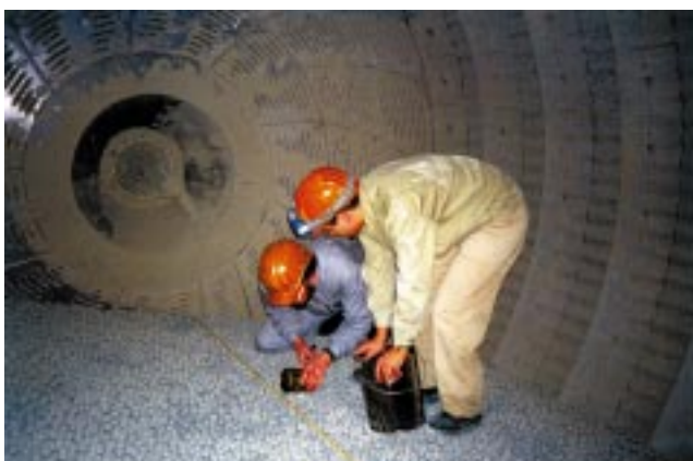
Bild 3: Mühlenversuch zur Optimierung des Energiebedarfs und der Kornverteilung des Zements
