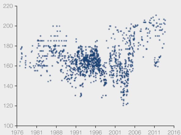
Abbildung 6.5: Ausbreitmaß von Normmörteln eines Referenzzements (CEM I 42,5 R) (Quelle: ibac RWTH Aachen)
